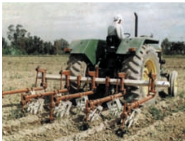
شکل ۲۴-۵ کولتیواتور غلتان معمول‌ترین ماشین وجین، سله‌شکنی و خاک‌دهی پای بوته
