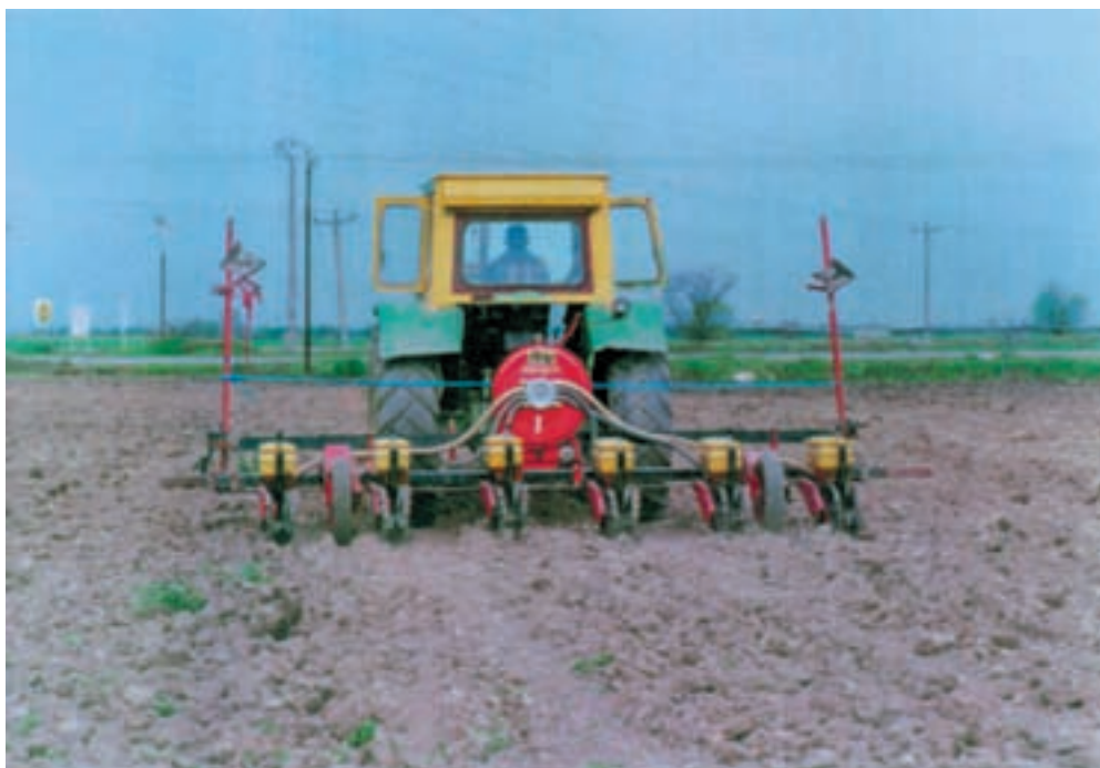
شکل ۴-۶- کاشت آفتابگردان با بذرکار پنوماتیکی
