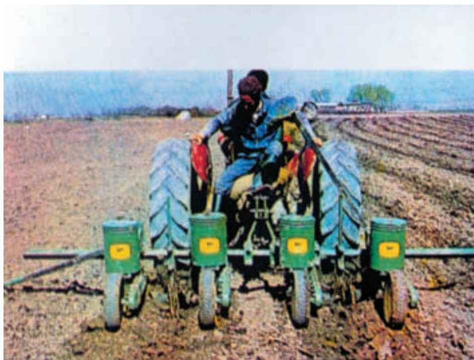
شکل ۴-۵- کاشت با استفاده از ردیفکار مکانیکی
