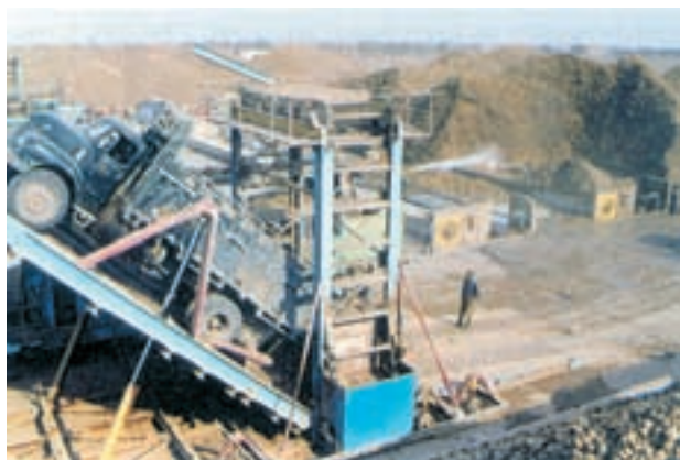
شکل ۱-۶- تخلیه چغندر در ابتدای خط کارخانه
