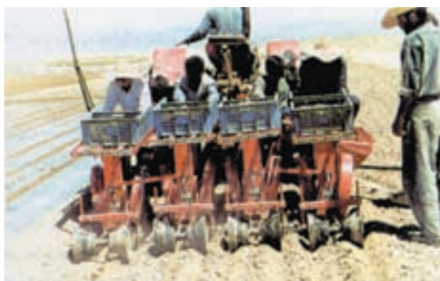
شکل ۱۲-۳- کاشت نشاها با ماشین نشاکار
