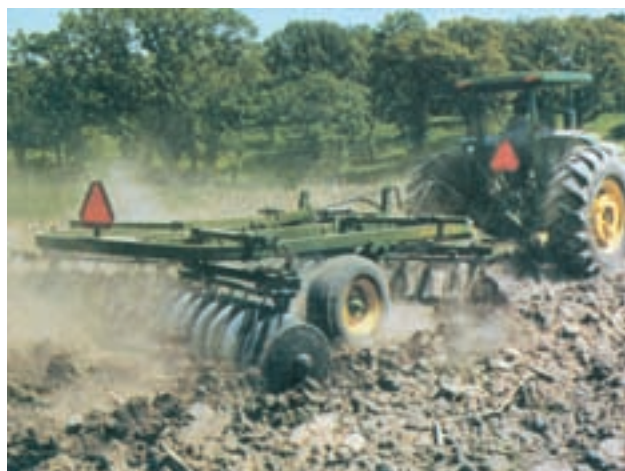
شکل ۳-۲- دیسک برای خرد کردن و مخلوط کردن بقایای گیاهی
