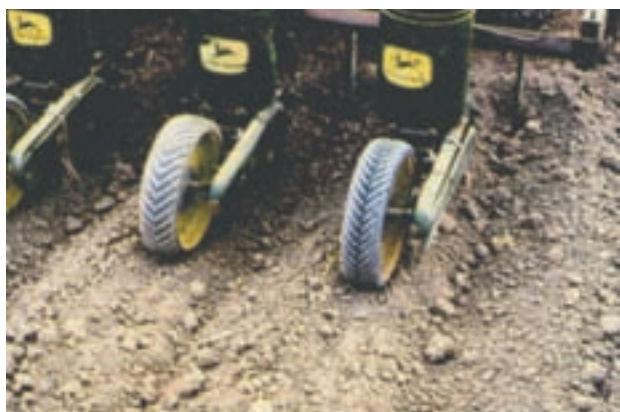
شکل ۵-۳- نحوه تنظیم بذرافشان تراکتوری در اراضی شور
