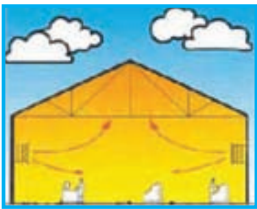
تصویر ۱-۲- مقایسه‌ی سیستم‌های گرمایشی جابه‌جایی و تابشی
