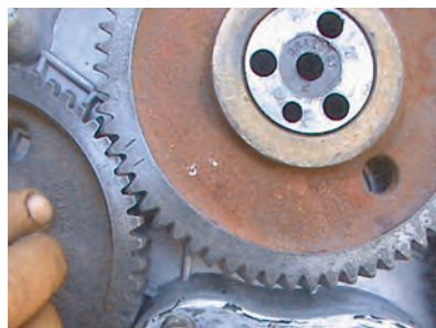
شکل ۱۵-۱- نشانه‌های روی چرخ دنده‌های سرپمپ انژکتور و واسطه میل لنگ
