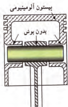
ج- انگشتی پرس شده داخل شاتون
