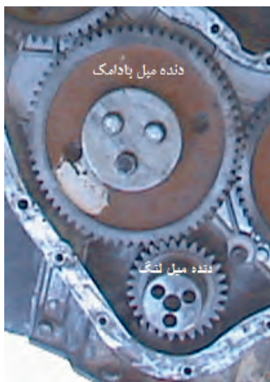
شکل ۱۲-۱- نسبت دنده میل بادامک به میل لنگ
