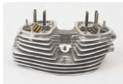
شکل ۱-۳- سر سیلندر موتور هوا خنک
