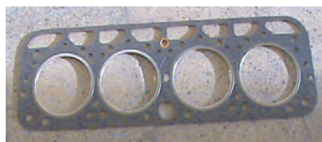
شکل ۷-۱- ورق فولادی اطراف لبه واشر سرسیلندر
