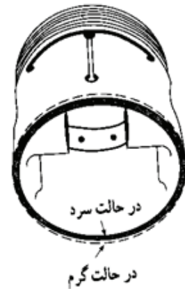
شکل ۱۹-۱- وضعیت پیستون در حالت گرم و سرد
