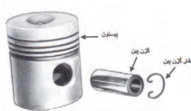
شکل ۳۰-۱- انگشتی و محل نصب آن روی پیستون
