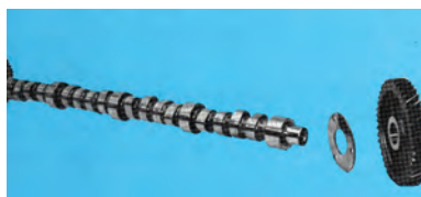
شکل ۱۱-۱- چرخ دنده سر میل بادامک
