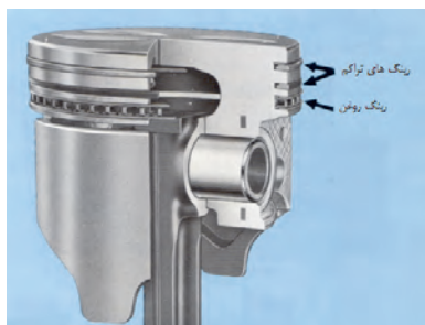
شکل ۲۲-۱ انواع رینگ روی پیستون
