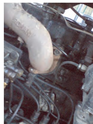
شکل ۳۱-۸- محل اتصال مانیفلد به سر سیلندر تراکتور U650
