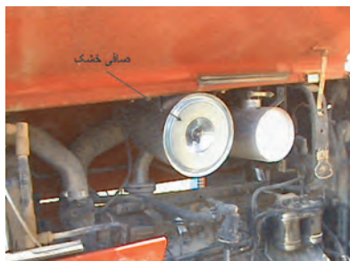
شکل ۶-۸- محل قرار گرفتن صافی خشک در تراکتور MF399
