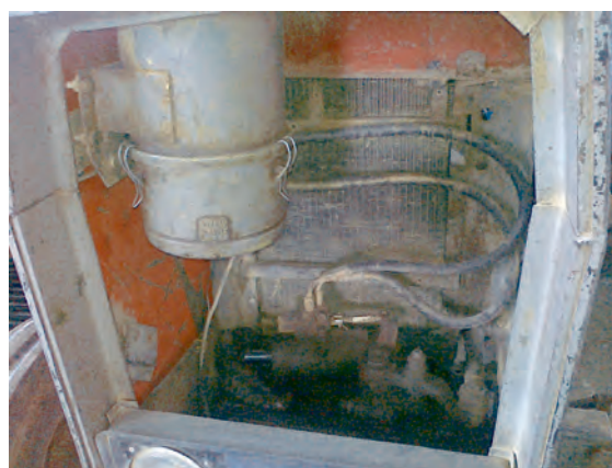
شکل ۱۰-۸- محل قرار گرفتن صافی هوا در تراکتور MF285
