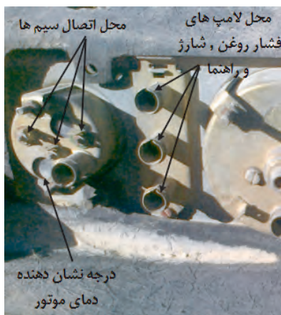
شکل ۸۶-۷- درجه نشان دهنده دمای آب از پشت داشبورد تراکتور U650
