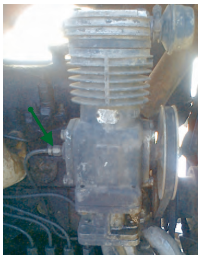
شکل ۵-۹- لوله روغن کاری کمپرسور در تراکتور U650
