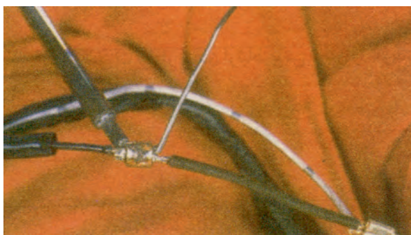
شکل ۶۵-۷- نحوه لحیم کاری سیم‌ها
