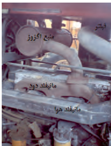
شکل ۲۲-۸- محل مانیفلد دود و هوا در تراکتور MF399
