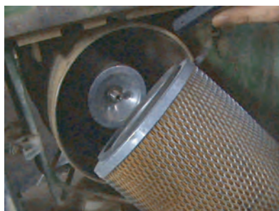
شکل ۵-۸- صافی خشک و محل قرار گرفتن آن
