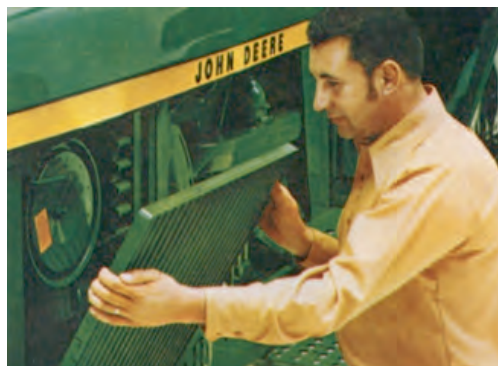
۲- شکل ۱۴-۸ باز کردن شبکه بغل
