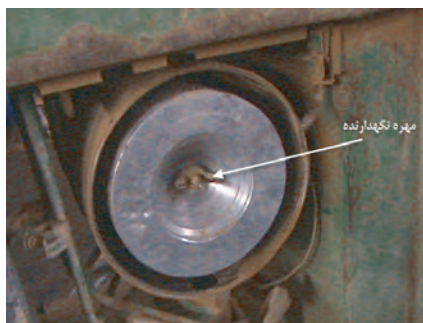
شکل ۱۶-۸ باز کردن مهره نگهدارنده و خارج کردن صافی
