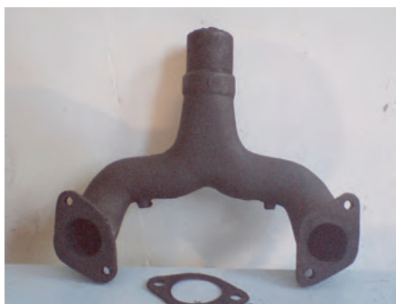
شکل ۲۱-۸-مانیفلد اگزوز تراکتور
