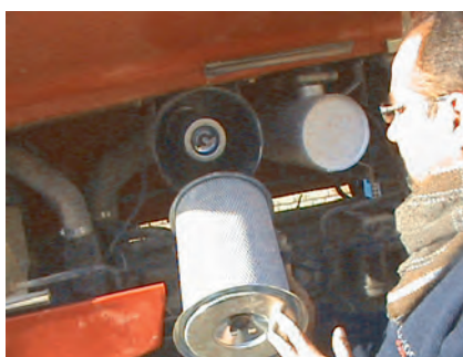
شکل ۱۶-۸ باز کردن مهره نگهدارنده و خارج کردن صافی
