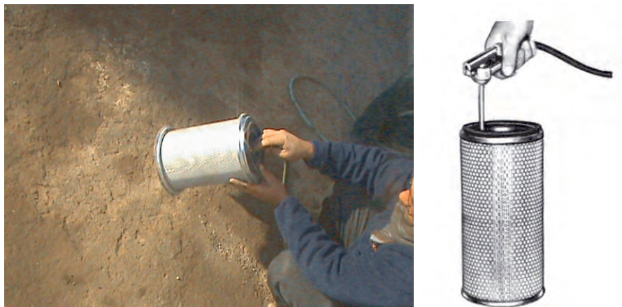
شکل ۱۸-۸- باد گردفتن صافی از داخل
