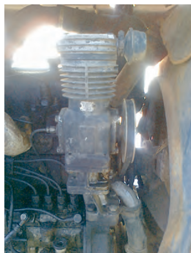
شکل ۲-۹- محل قرار گرفتن پمپ باد در تراکتور U650
