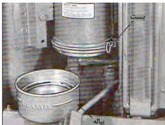
شکل ۱۱-۸- باز کردن پیاله زیر صافی
