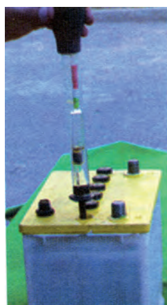
شکل ۴-۷- نحوه اندازه گیری غلظت محلول الکترولیت باتری با هیدرومتر دستی
