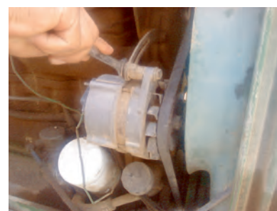
شکل ۳۹-۷- سفت کردن پیچ تنظیم آلترناتور
