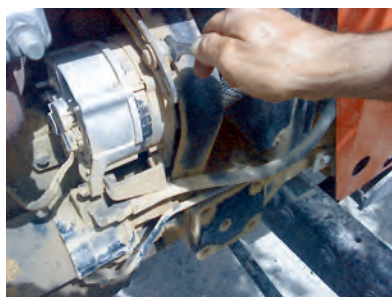
شکل ۲۹-۷- جدا کردن فیش از آلترناتور
