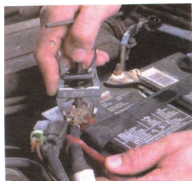
شکل ۸-۷- باز کردن بست مثبت باتری
