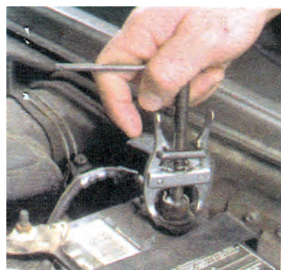
شکل ۷-۷- جدا کردن بست باتری از قطب منفی بوسیله ابزار مخصوص
