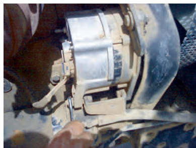
شکل ۳۲-۷- باز کردن پیچ پایه آلترناتور
