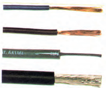
شکل ۵۶-۷- انواع سیم‌های مورد استفاده در مدارهای تراکتور
