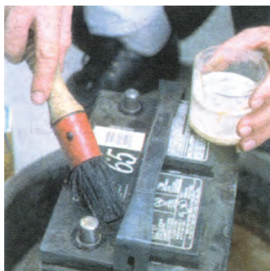
ب- تمیز کردن با قلم مویی و محلول جوش شیرین
