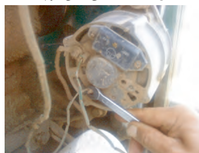
شکل ۳۶-۷- بستن سیم نازک
