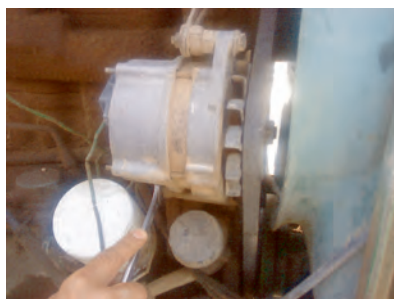
شکل ۴۰-۷- سفت کردن پیچ پایه
