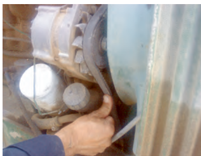
شکل ۳۷-۷- فشار دادن تسمه با شست
