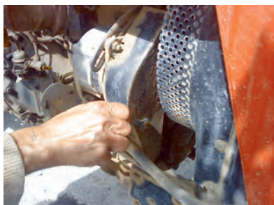
شکل ۳۳-۷- باز کردن روکش محافظ تسمه
