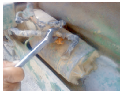
شکل ۵۰-۷- باز کردن کابل مثبت از استارتر
