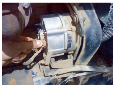
شکل ۳۰-۷- شل کردن پیچ و مهره تنظیم
