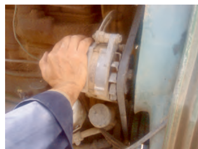
شکل ۳۱-۷- فشار دادن آلترناتور به عقب
