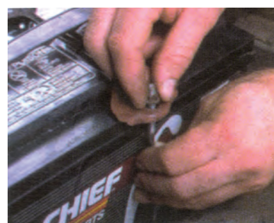
شکل ۹-۷- باز کردن بست نگهدارنده باتری
