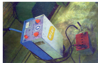
شکل ۱۹-۷- اتصال کابل های شارژر به باطری
