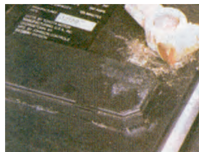
شکل ۲۲-۷- سولفاته کردن بست مثبت باتری
