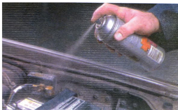
شکل ۱۱-۷- پاشیدن اسپری ضد خوردگی روی بست باتری
