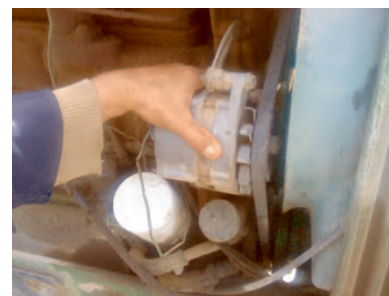
شکل ۳۸-۷- عقب کشیدن آلترناتور
