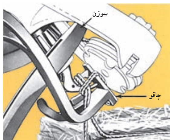
شکل ۳-۴- قلاب گره‌زن برای گرفتن نخ باز شده است.
