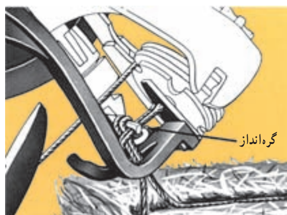
شکل ۳-۵- آرواره‌ی قلاب گره‌زن بسته شده است. چاقو نخ را بریده است.
