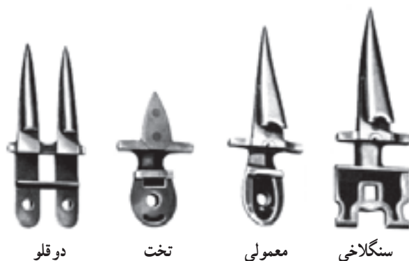
شکل ۱-۳۴- انواع مهم انگشتی‌ها
