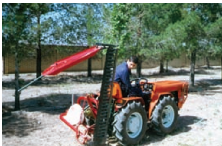
شکل ۵-۱- دروگر شانه‌ای متصل به تراکتور باغی
