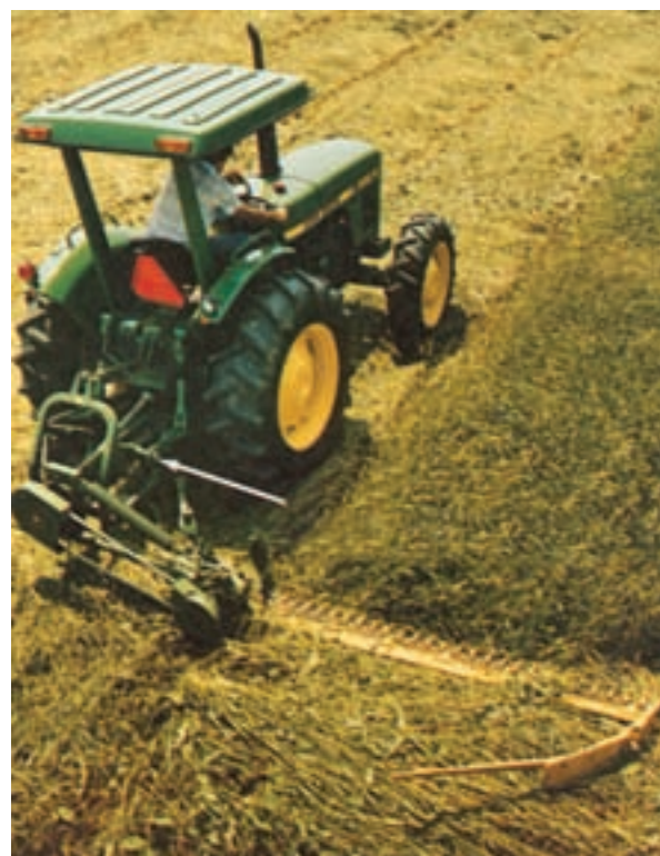
شکل ۹-۱- دروگر شانه‌ای سوار
