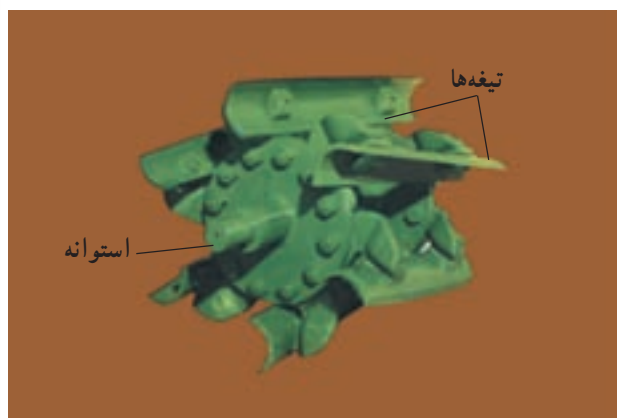
شکل ۳-۲- استوانه خردکننده به همراه تیغه‌ها
