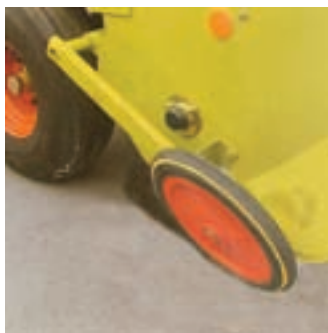
شکل ۳۹-۱- چرخ تنظیم کج شده
