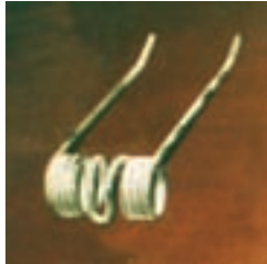
شکل ۱۸-۱- انگشتی کج شده، شکسته و ساییده شده
