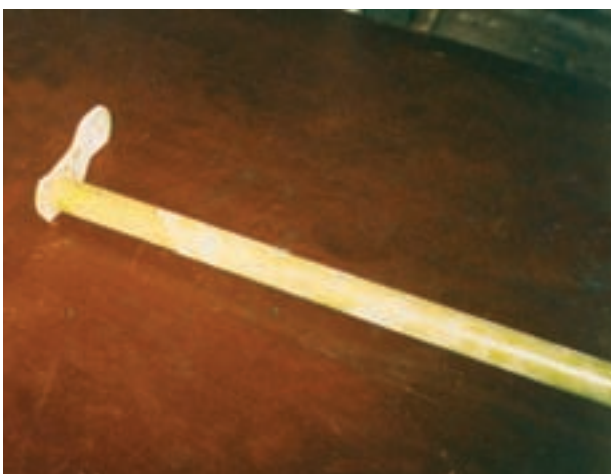
شکل ۲۶-۱- پایه کج شده بلبرینگ انگشتی
