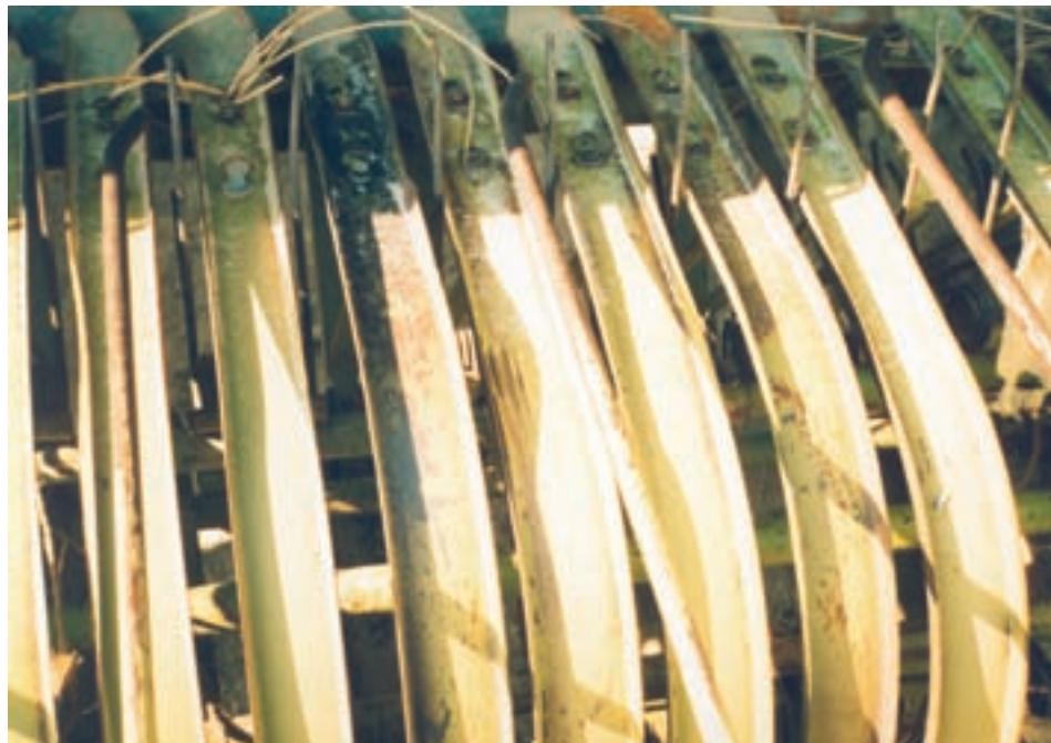
شکل ۱۹-۱- ساییده شدن انگشتی‌ها به طوقه‌ها
