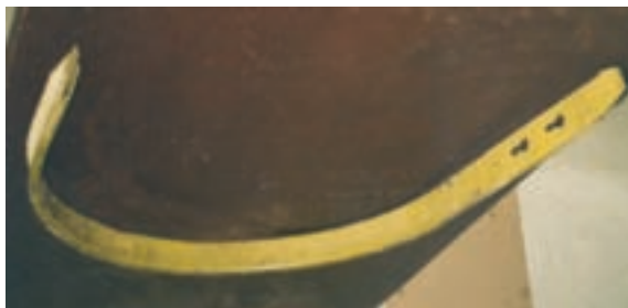
شکل ۳۲-۱- طوقه شکسته و کج شده
