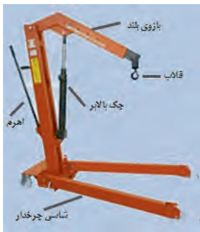
شکل ۱۱-۴- اجزای جرثقیل متحرک دستی
