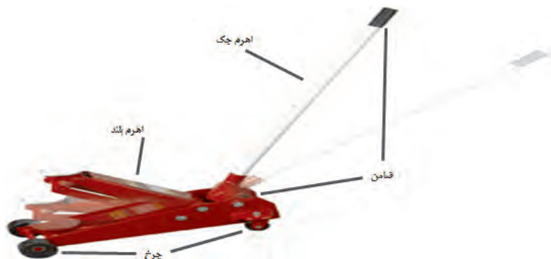
شکل ۸-۴ اجزای جک سوسماری
