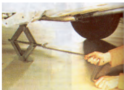
ب- شکل واقعی جک شکل ۴-۴- جک کشویی
