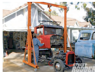
شکل ۱۷-۴- جرثقیل دروازه‌ای متحرک
