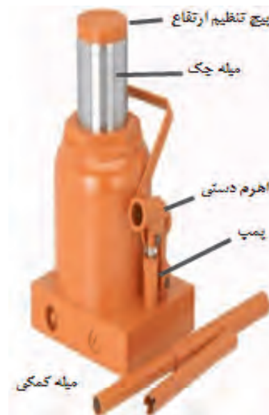
شکل ۶-۴ اجزای جک روغنی
