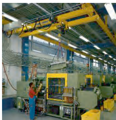
شکل ۱۶-۴- کاربرد جرثقیل دروازه‌ای
