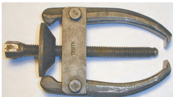
شکل ۲۴-۴- پولی کش دو فکی
