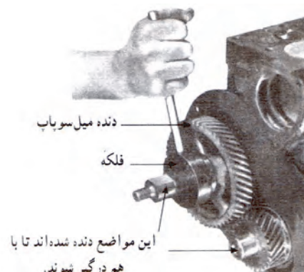
شکل ۲۹-۴- نحوه خارج کردن چرخ دنده از روی شافت با پولی کش مخصوص
