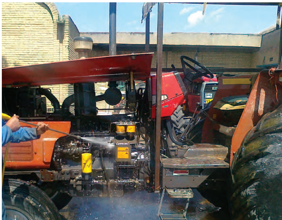
شکل ۶-۵ نحوه شستشوی موتور تراکتور
