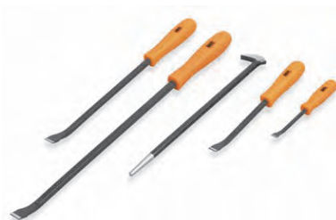
الف- اهرم خارج کردن انژکتور
