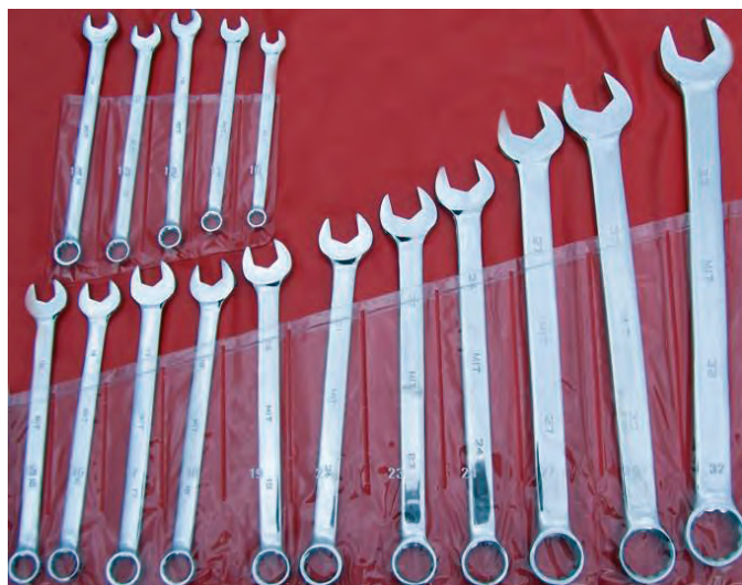
شکل ۳-۴۸- انواع آچار یک سر رینگی
