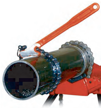
شکل ۸۱-۳- نحوه استفاده از آچار لوله گیر زنجیری
