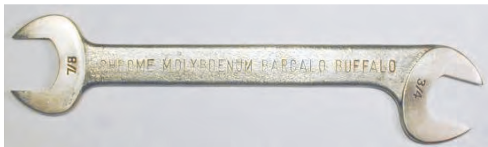
شکل ۴۳-۳- آچار تخت با سر زاویه دار
