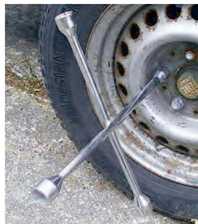
شکل ۶۴-۳- نحوه استفاده از آچار چرخ
