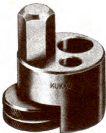
شکل ۷۶-۳- آچار پیچ‌های دو سر
