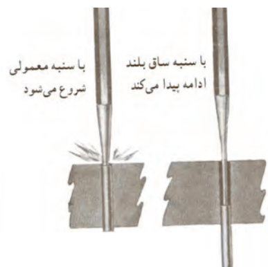
شکل ۹۳-۳- خارج کردن پین با سنبله
