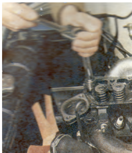
شکل ۵۷-۳- نحوه استفاده از آچار بکس
