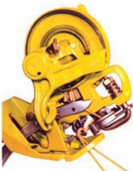
x = 28 - 29 \text{ mm} - ۱ - تسمه ترمز F - فنر فشار شکل ۳-۳۵
