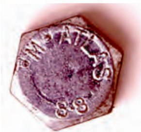
شکل ۱۷-۳ اعداد حک شده روی سر پیچ
