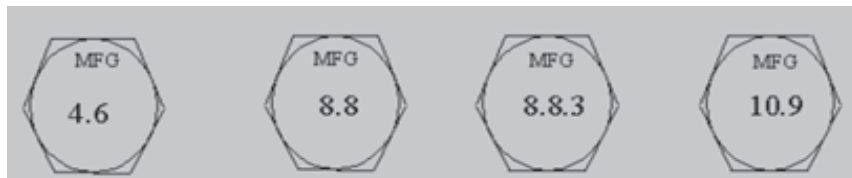
شکل ۱۸-۳ نمونه اعداد حک شده روی پیچ
