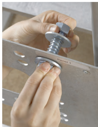
شکل ۱-۳- استفاده از پیچ و مهره برای اتصال
