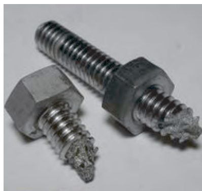
شکل ۳-۳۱- بریدن ساق پیچ
