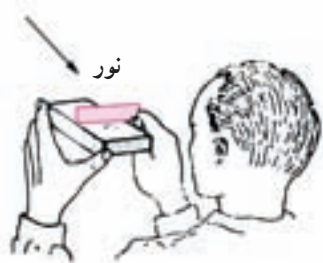
شکل ۱-۲۳- کنترل زاویه قائمه با گونیا
