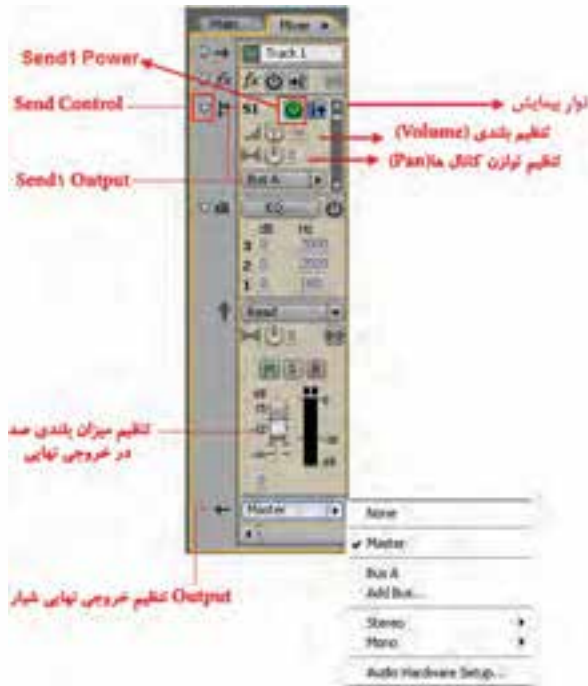
شکل ۱۴-۱۰ کنترل‌های مسیریابی شیار
