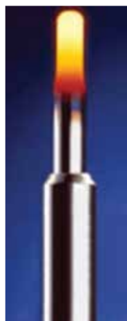
شکل ۱۳-۳- شمع گرم کن در حالت گداخته بودن
