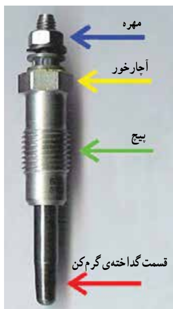
شکل ۱۳-۲- شمع گرم کن موتور دیزل
