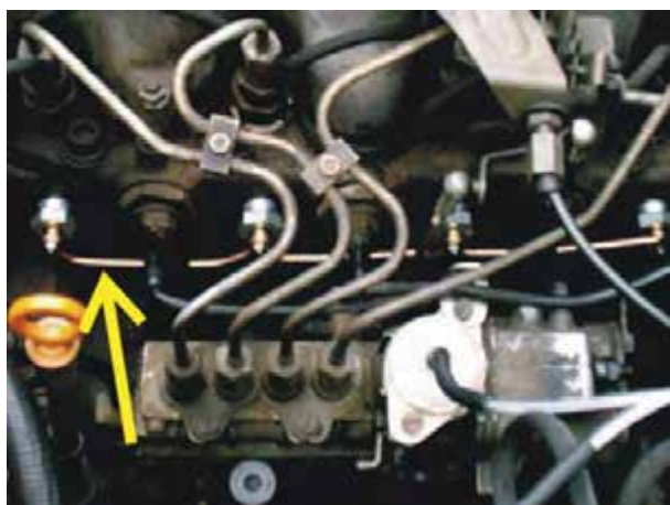
شکل ۷-۱۳- اتصال سری شمع گرم کن
