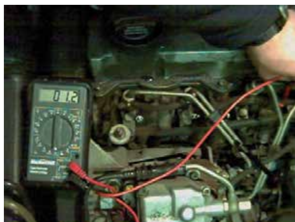
شکل ۱۳-۲۳ اندازه‌گیری مقاومت شمع گرم‌کن سیلندر چهارم
