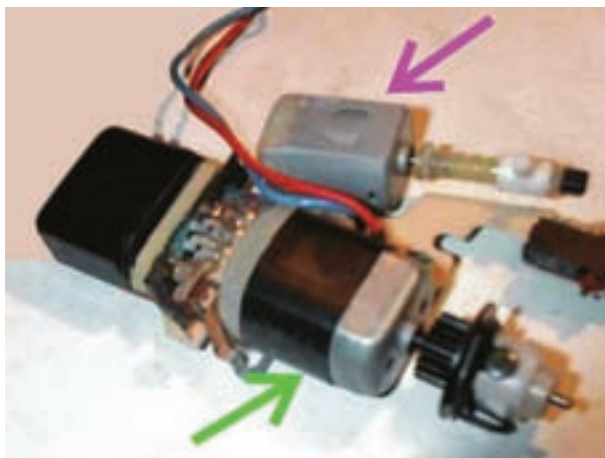
شکل ۱۶۰-۲- الکتروموتورهای مورد استفاده در یک نوع آیینی جانبی
