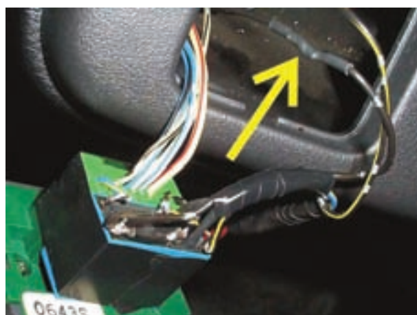
شکل ۱۹۴-۲- عایق‌کاری سیم مدار الکتریکی
