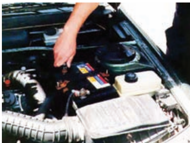
شکل ۱۶۴-۲ بازکردن کابل اتصال بدنه‌ی باتری
