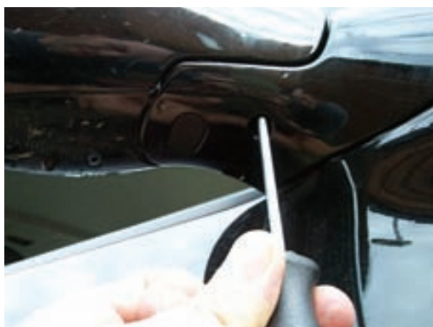
شکل ۱۷۶-۲- بازکردن پیچ روی پایه ی بیرونی آینه
