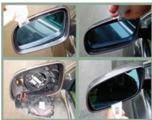
شکل ۱۶۷-۲- بیرون آوردن آینه از داخل قاب آن
