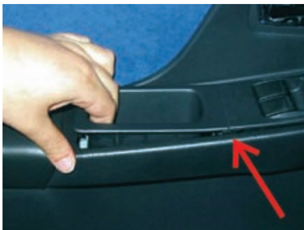
شکل ۱۸۳-۲- خارج نمودن قاب سوئیچ‌ها
