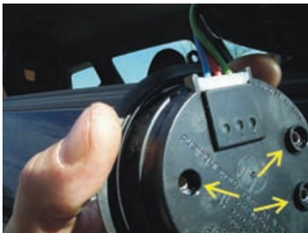
شکل ۱۷۲-۲- جدا کردن محفظه‌ی موتورهای الکتریکی
