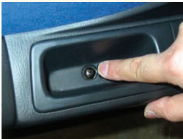
شکل ۱۸۲-۲- پیچ اتصال قاب سوئیچ به بدنه
