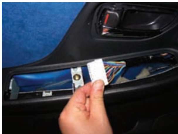
شکل ۱۸۵-۲- سوکت اتصال دسته سیم به سوئیچ‌ها
