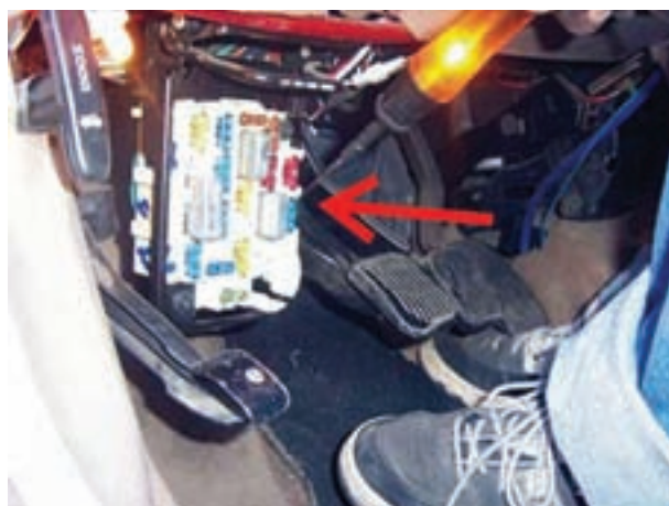
شکل ۱۸۹-۲- آزمایش پایه‌های فیوز
