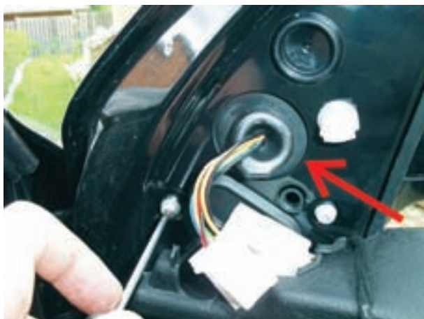
شکل ۱۷۸-۲- باز کردن پیچ نگه دارنده‌ی پایه‌ی اصلی آئینه
