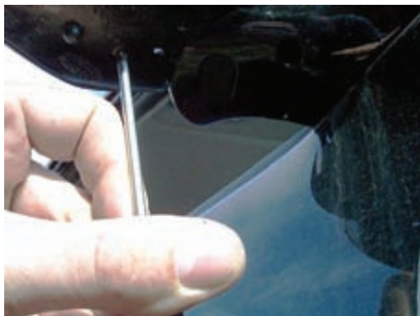
شکل ۱۷۵-۲- بازکردن پیچ پایین قاب بیرونی آینه
