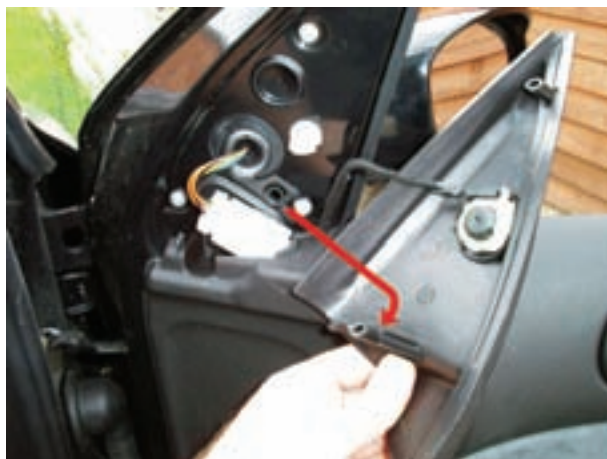
شکل ۱۶۵-۲ خارهای روی قاب و محل نصب آن
