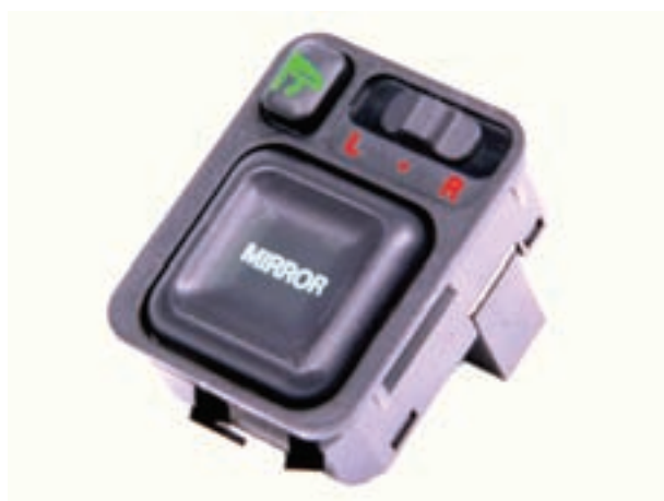
شکل ۱۹۱-۲- سوئیچ آینه های جانبی یک نوع خودرو
