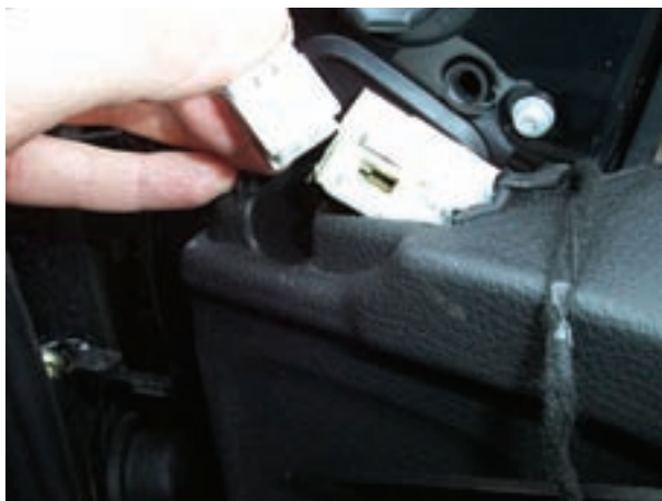
شکل ۱۶۶-۲- جدا کردن سوکت سیم کشی آینه
