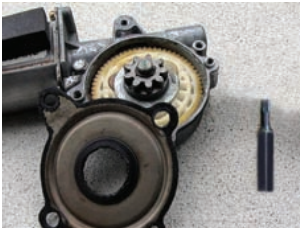
شکل ۱۲۴-۲- اجزای داخل جعبه دنده‌ی تعدیل دور
