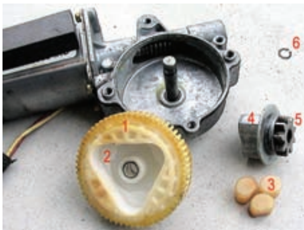
شکل ۱۲۵-۲- اجزای داخل پوسته‌ی گیربکس تعدیل دور
