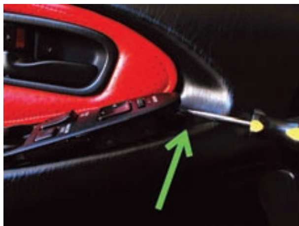
شکل ۱۴۲-۲- خارج کردن قاب سوئیچ شیشه بالابر
