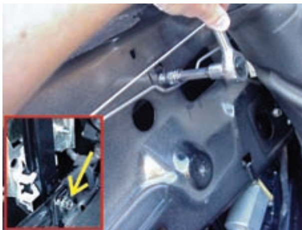
شکل ۱۲۰-۲- باز کردن پیچ ریل شیشه بالابر
