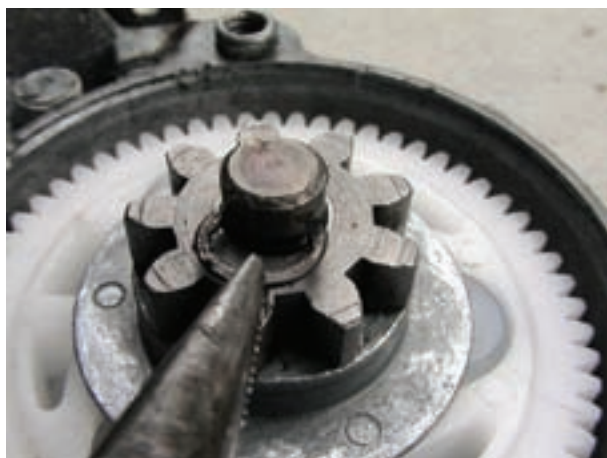
شکل ۱۲۹-۲ جانداختن خار فنری
