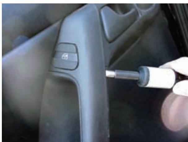
شکل ۲-۱۱۰- جدا کردن قاب سوئیچ شیشه بالابر
