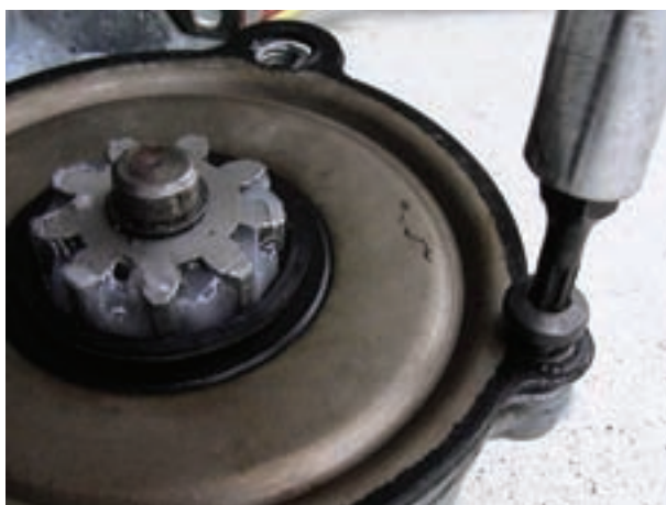
شکل ۱۳۱-۲- بستن پیچ‌های درپوش به بدنه
