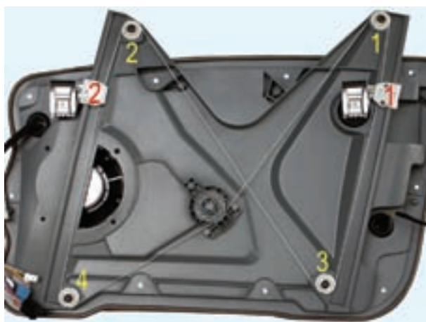
شکل ۱۰۶-۲- نحوه‌ی ارتباط رگلاتورهای مکانیزم شیشه بالابر
