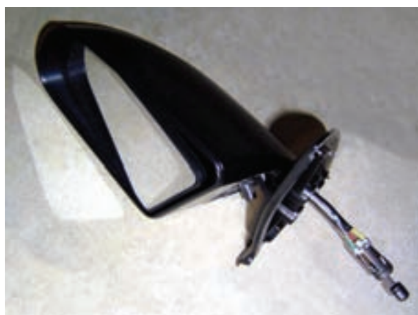
شکل ۱۵۶-۲- آینه‌ی جانبی و مکانیزم حرکت آن
