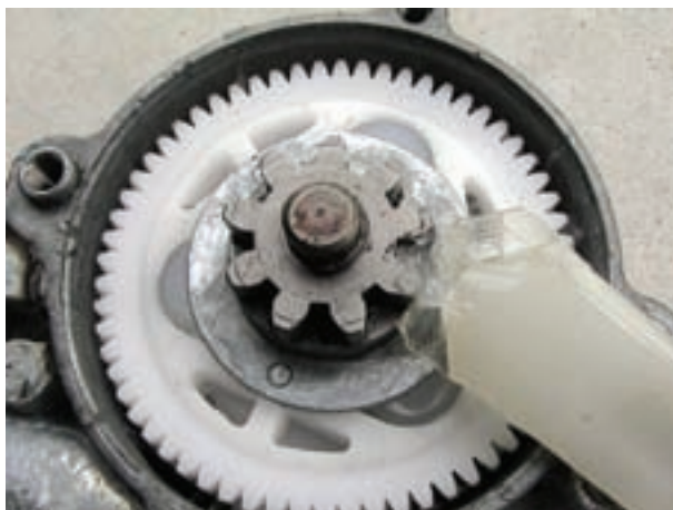
شکل ۱۳۰-۲- روغن کاری چرخ دنده‌ها
