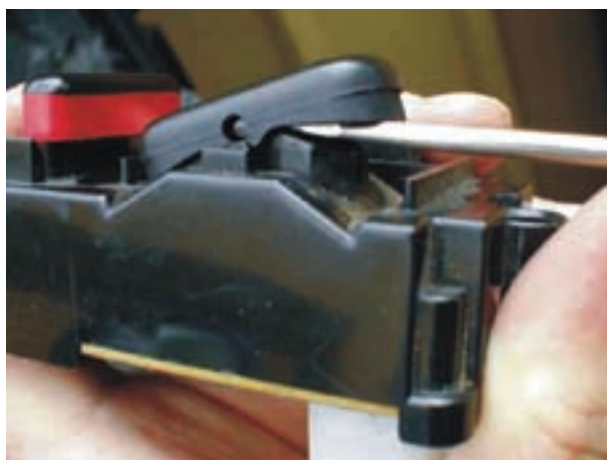
شکل ۲-۱۴۵- تعویض شستی معیوب
