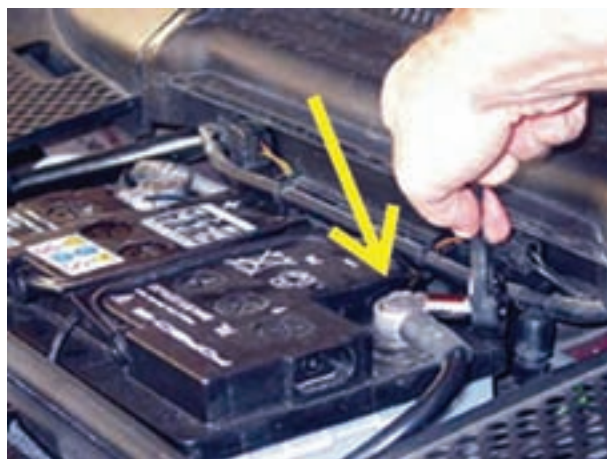
شکل ۱۴۱-۲- باز کردن کابل اتصال بدنه‌ی باتری
