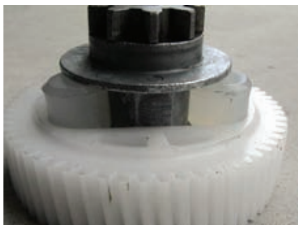
شکل ۱۲۸-۲ سوار کردن چرخ دنده‌ی فلزی
