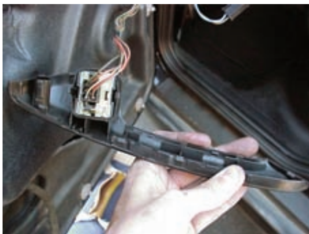
شکل ۱۱۸-۲- اتصال سوکت سوئیچ شیشه بالابر
