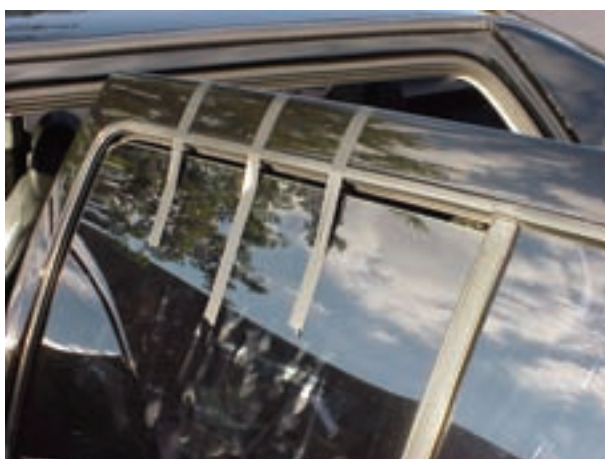
شکل ۱۱۹-۲- مهار کردن شیشه ی در به وسیله ی نوار چسب
