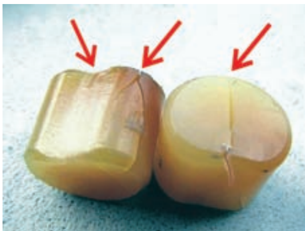
شکل ۱۲۶-۲- معیوب بودن بادامک‌ها
