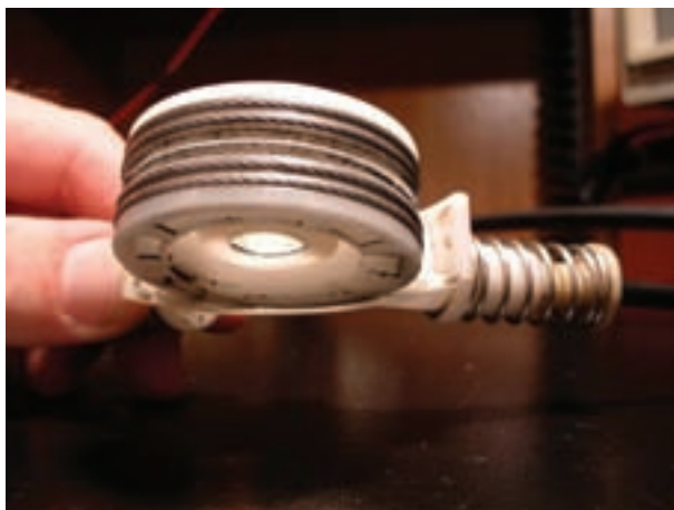
شکل ۱۰۷-۲- پولی اصلی مکانیزم شیشه بالابر یک نوع خودروی سواری
