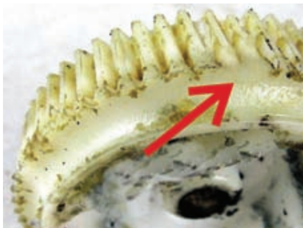
شکل ۱۲۷-۲ وجود عیب در چرخ دنده
