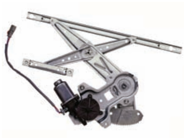
شکل ۲-۹۹- مکانیزم شیشه بالابر یک نوع خودرو
