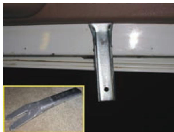
شکل ۲-۳۵- اهرم خاردرآر و نحوه‌ی استفاده از آن
