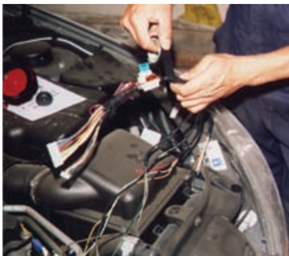
شکل ۲-۷۷- نحوه‌ی عایق‌بندی سیم‌های مدار الکتریکی دزدگیر
