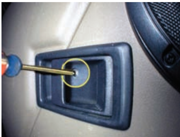
شکل ۳۶-۲- باز کردن قاب دستگیره‌ی قفل در
