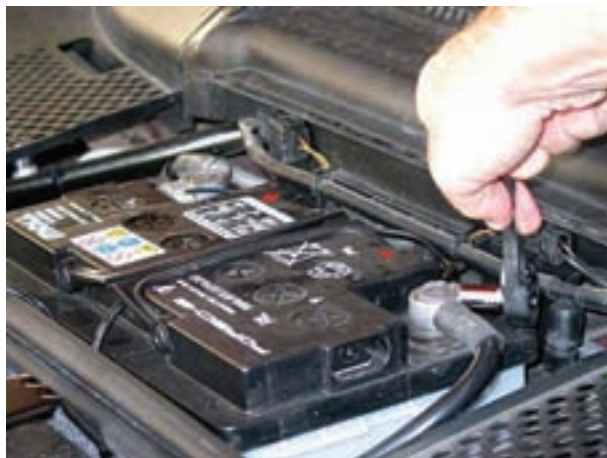
شکل ۲-۳۳- باز کردن اتصال بدنه‌ی باتری
