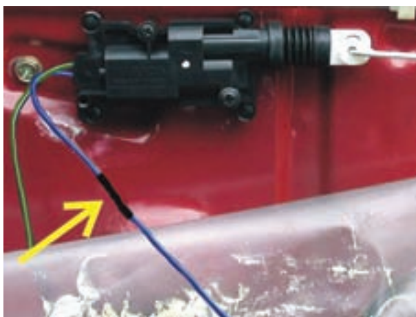
شکل ۲-۴۹- عایق کاری محل اتصال سیم‌ها به یکدیگر
