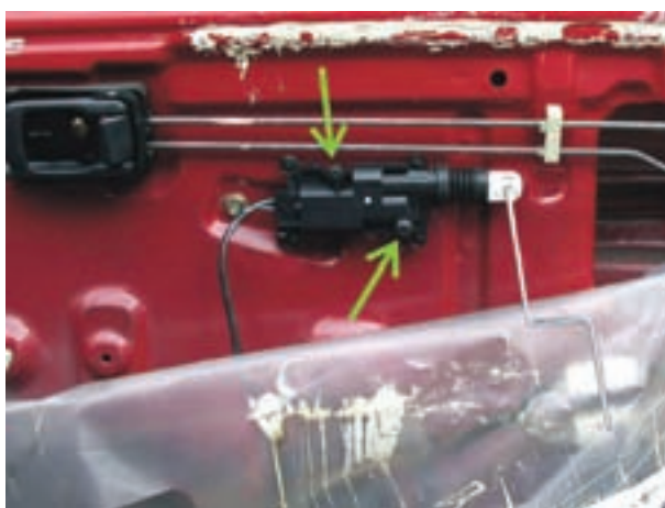
شکل ۲-۲۹ اتصال عملگر الکتریکی در روی در خودرو
