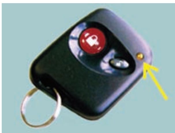
شکل ۲-۷- دیود نوری روی قاب ریموت کنترل
