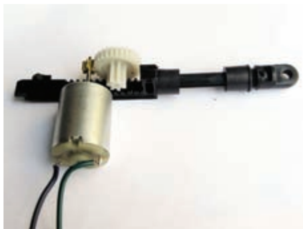
شکل ۲۰-۲- نحوه‌ی ارتباط چرخ‌دنده‌ها هنگام تبدیل دور
