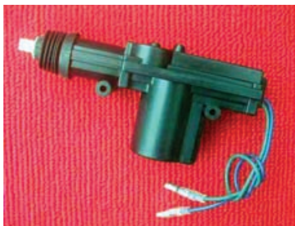
شکل ۲-۸- یک نوع عملگر سیستم قفل مرکزی
