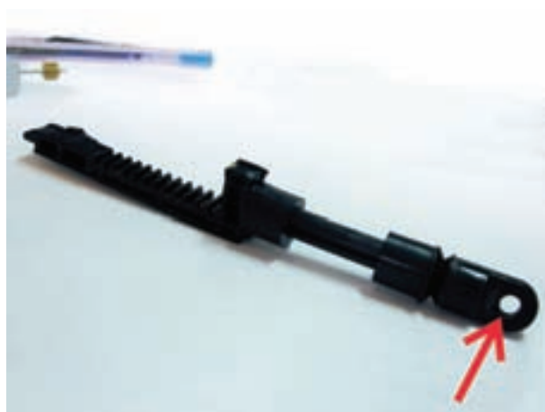
شکل ۱۸-۲- شانه‌ی دندانه‌دار دو قسمتی (محور عملگر)
