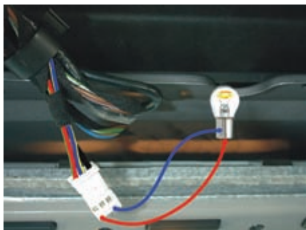
شکل ۱-۲۳۷- آزمایش سیم کشی مدار چراغ فندک
