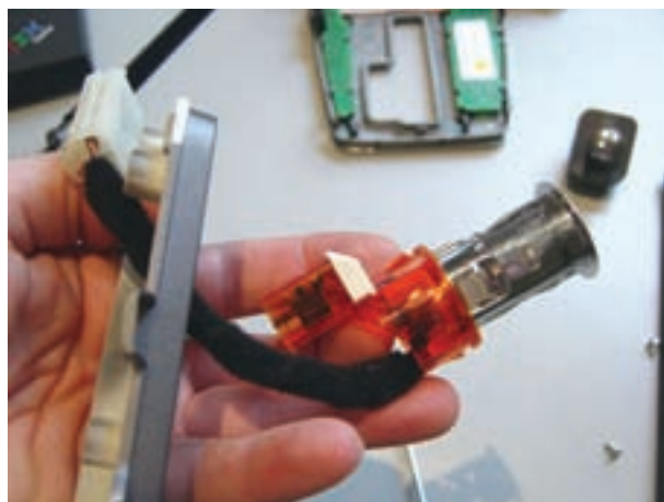
شکل ۲۳۴-۱- خارج کردن سیم و سوکت اتصال الکتریکی فندک از داخل قاب روی پانل
