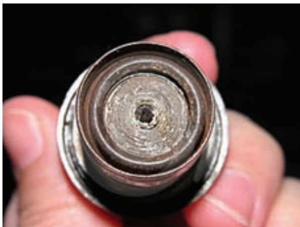
شکل ۱-۲۲۵- المنت حرارتی داخل سوئیچ فشاری
