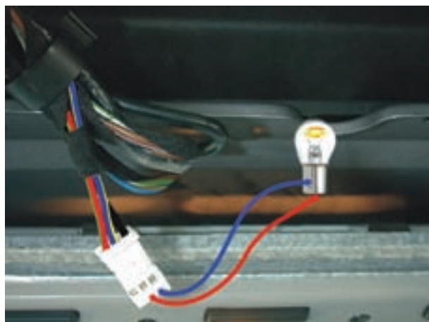
شکل ۱-۲۳۶- آزمایش سیم کشی مدار فندک
