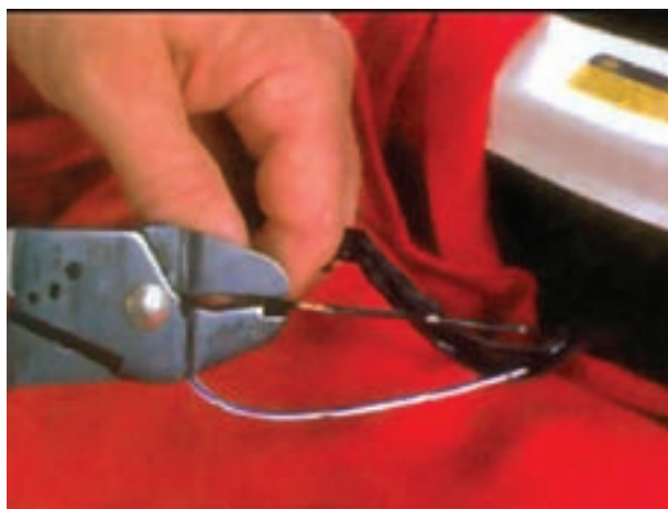
شکل ۱۴۶-۱- استفاده از انبر مخصوص برای قطع سیم
