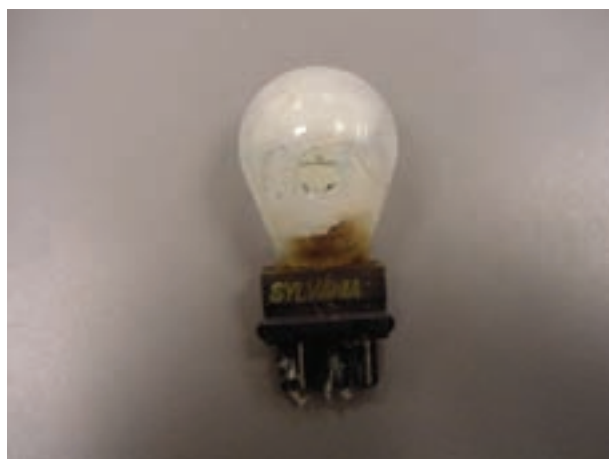
شکل ۱۴۱-۱- اثر عوامل فیزیکی در معیوب شدن لامپ
