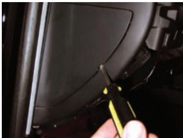
شکل ۱۱۸-۱- آزاد کردن خار پوشش محافظه‌ی جعبه‌ی فیوز
