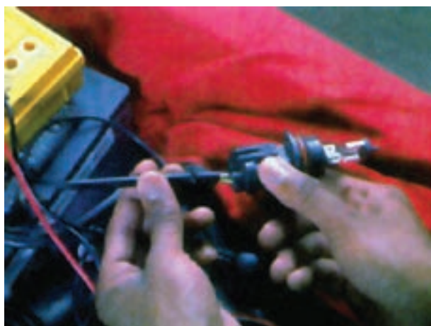
شکل ۱۴۲-۱- آزمایش لامپ چراغ‌های بزرگ جلو
