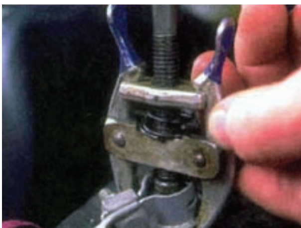
شکل ۱-۸۹- باز کردن بست اتصال بدنه‌ی باتری
