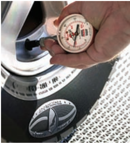
شکل ۱۵۸-۱- کنترل فشار باد تایر
