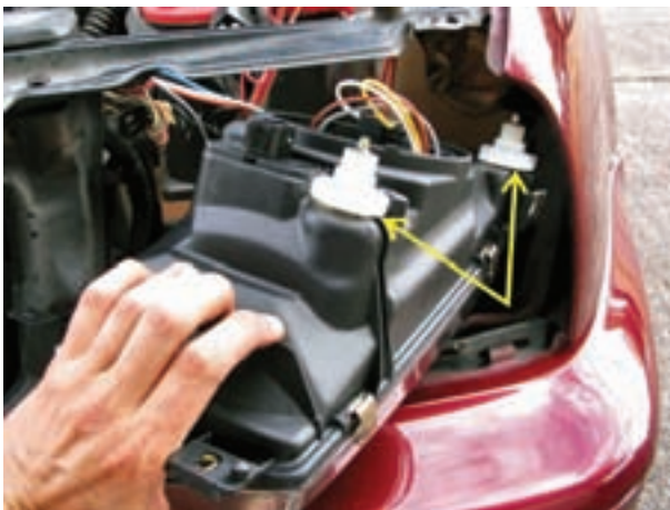
شکل ۱-۱۵۶- اهرم تنظیم کاسه چراغ یک نوع خودرو
