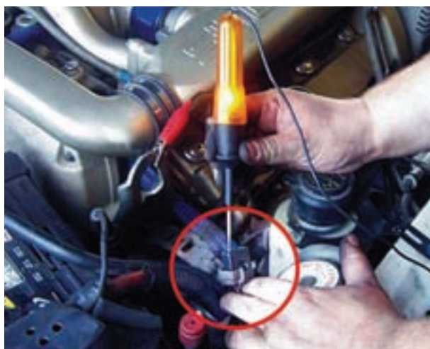
شکل ۱۴۵-۱- آزمایش برقراری جریان مدار چراغ های روشنایی
