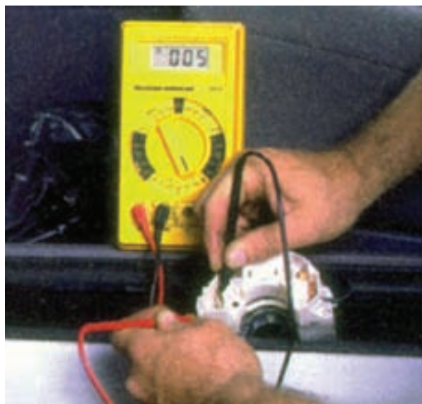
شکل ۹۷-۱- آزمایش سوئیچ روشنایی
