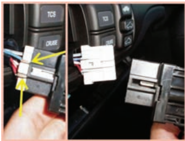
شکل ۱-۸۸- جدا کردن سوکت اتصال الکتریکی سوئیچ چراغ‌های بزرگ
