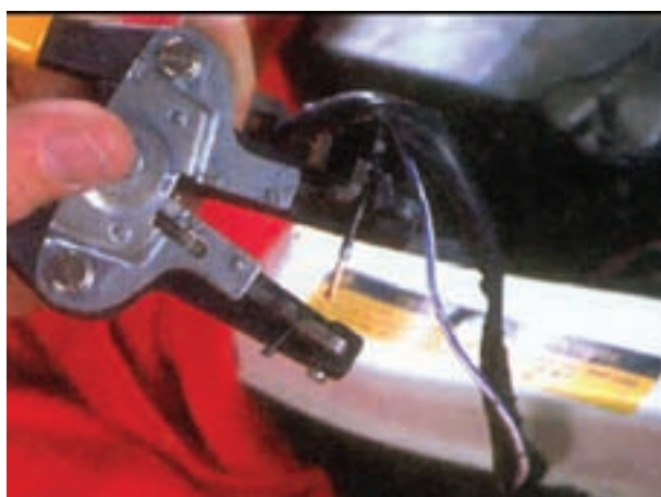
شکل ۱۴۷-۱- استفاده از ابزار سیم لخت کن
