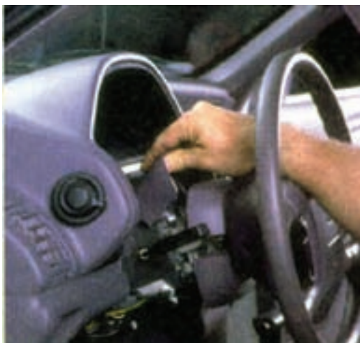
شکل ۹۱-۱- بیرون آوردن قاب سوئیچ روشنایی
