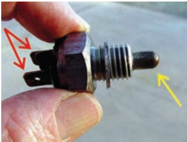
شکل ۱۰۴- پلانجر و ترمینال‌های سوئیچ دنده عقب
