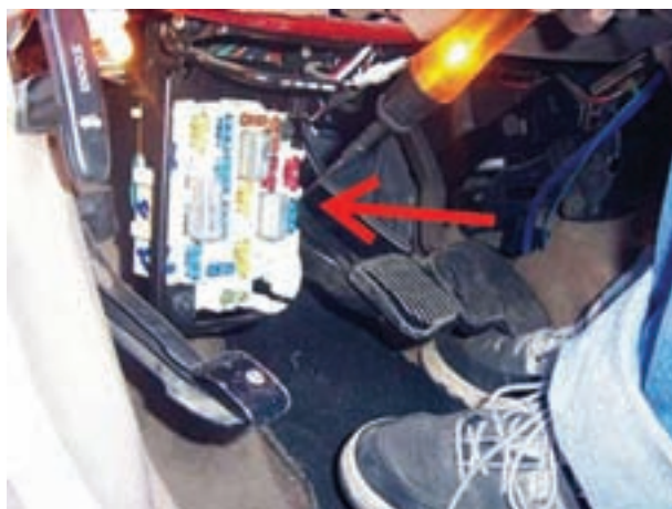
شکل ۱۲۰-۱- آزمایش جعبه‌ی فیوز با چراغ آزمایش
