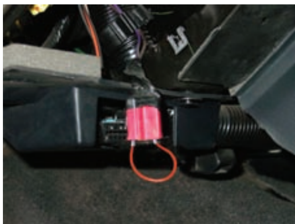
شکل ۱-۱۲۹- یک سره کردن مدار راهنما
