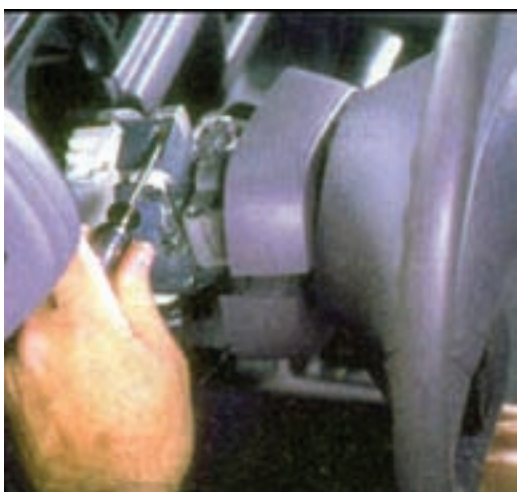
شکل ۹۵-۱- باز کردن پیچ بدنه سوئیچ روشنایی
