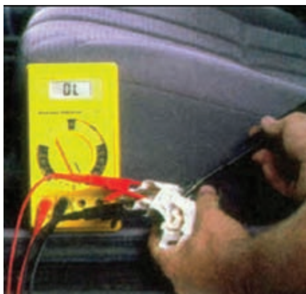
شکل ۹۸-۱- آزمایش حالت استپ موقت دسته ی راهنما
