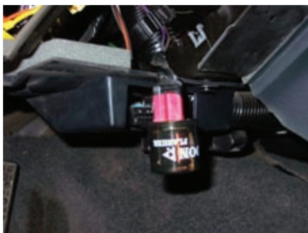
شکل ۱-۱۲۸- خارج نمودن اتوماتیک راهنما از محل خود در داخل
