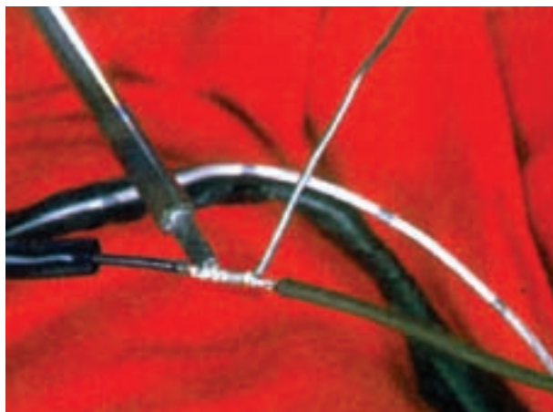
شکل ۱-۱۴۹- لحیم کاری محل اتصال سیم ها
