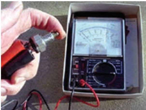
شکل ۱۰۵-۱- آزمایش سوئیچ چراغ‌های دنده عقب
