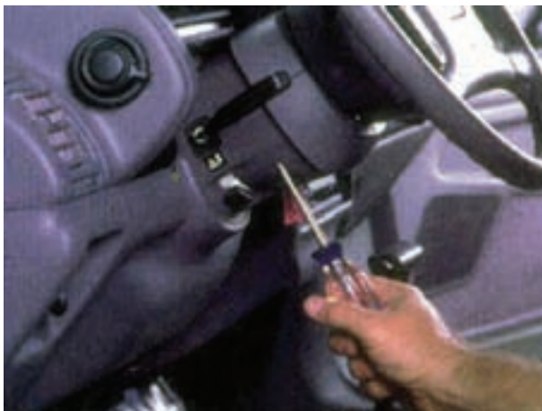
شکل ۱-۹۰- باز کردن پیچ‌های قاب سوئیچ روشنایی
