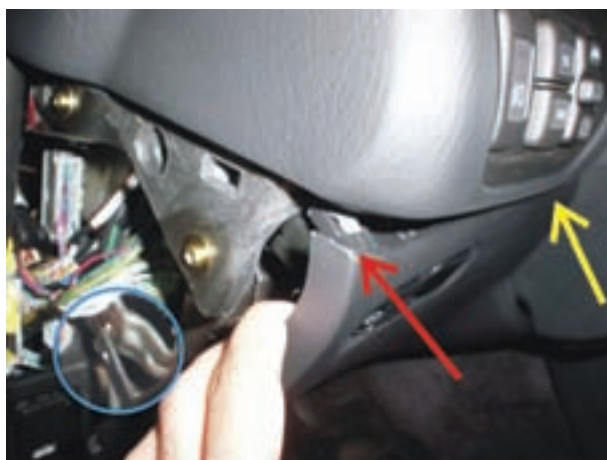
شکل ۱-۸۵- خارج کردن قاب از روی بدنه‌ی پانل
