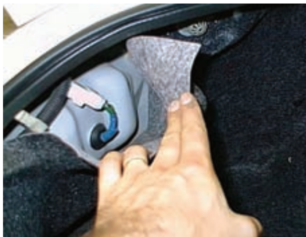
شکل ۱-۵۳- جدا کردن پوشش صندوق عقب از محل چراغ‌ها
