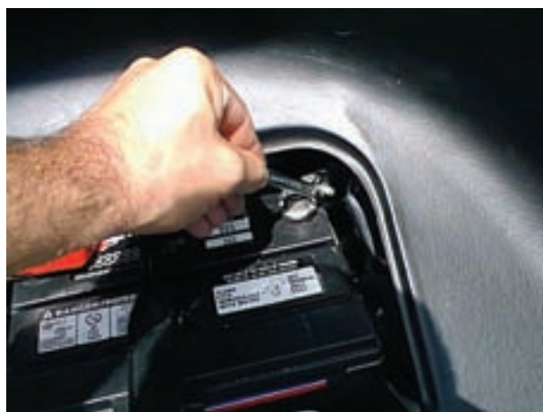
شکل ۱-۵۲ باز کردن بست ترمینال منفی باتری
