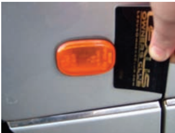
شکل ۶۶-۱- نحوه‌ی بیرون آوردن چراغ راهنمای بغل یک نوع خودرو
