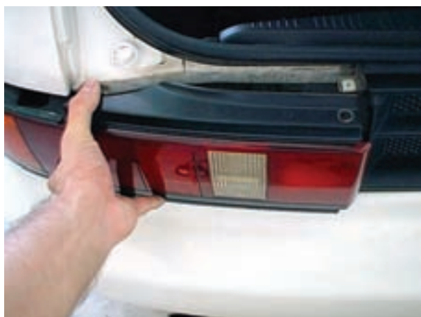
شکل ۱-۵۸- جدا کردن چراغ عقب از بدنه‌ی خودرو
