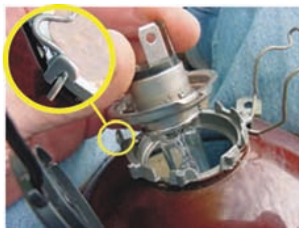
شکل ۱-۴۳- نحوه‌ی ثابت شدن لامپ درون کاسه‌ی چراغ
