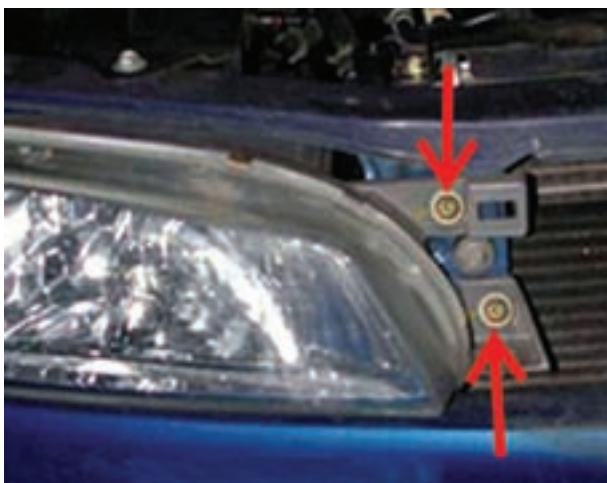
شکل ۱-۴۰- پیچ‌های نگه‌دارنده‌ی چراغ‌های بزرگ جلو
