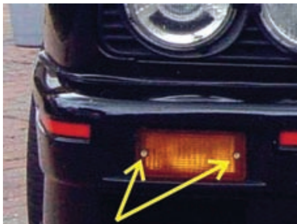
شکل ۱-۵۰ پیچ‌های اتصال تلق چراغ راهنما
