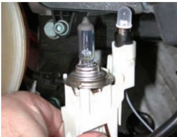
شکل ۱-۴۹ - پایه‌ی مشترک لامپ‌های چراغ روشنایی و پارک
