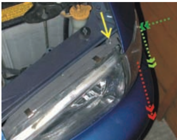
شکل ۱-۳۸- نحوه‌ی جداکردن چراغ جانبی روشنایی
