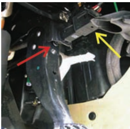
شکل ۱-۷۷- محل نصب سوئیچ مکانیکی ترمز
