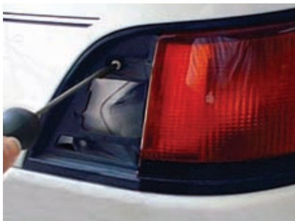
شکل ۱-۵۶- باز کردن پیچ‌های قاب چراغ
