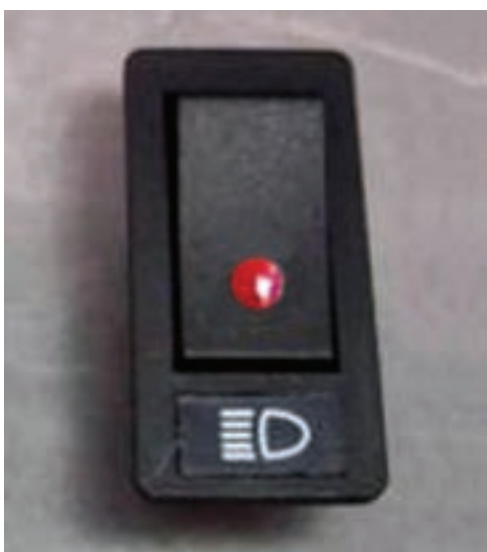
شکل ۸۱-۱- سوئیچ چراغ‌های جانبی (پارک)
