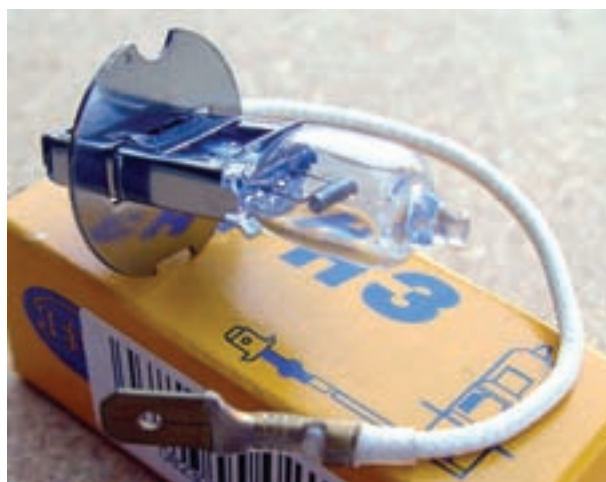
شکل ۱-۳۱- لامپ مورد استفاده در چراغ‌های مه‌شکن، نورافکن‌ها
