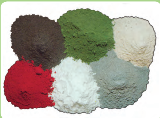
مواد پودری تشکیل دهنده روپوش الکتروده
