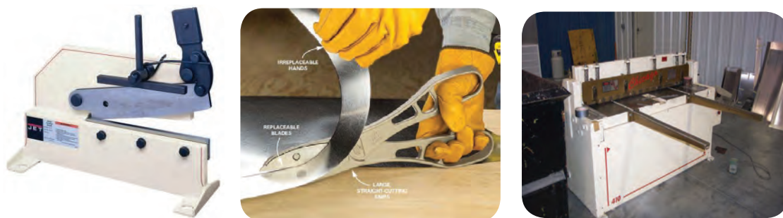
ابزار برشکاری که بدون بهره برداری عمل برش را انجام می دهند
