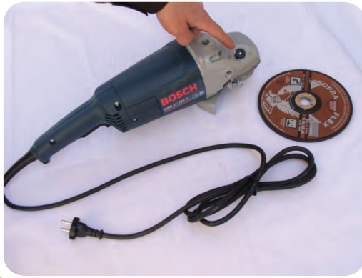
کلید مخصوص قفل کردن محور سنگ
