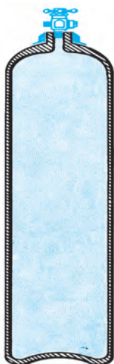
کپسول فولادی مخصوص برای ذخیره اکسیژن
