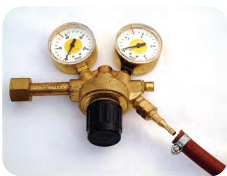
اتصال شیلنگ به رگولاتور گاز
