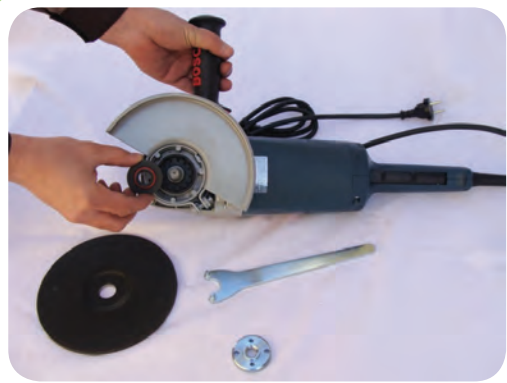
خارج کردن صفحه سنگ و مهره زیر صفحه از روی محور سنگ
