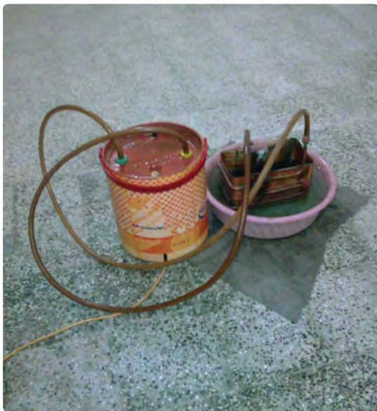
شکل ۲۱-۴- رسوب زدایی مبدل آب گرم کن با دستگاه ویژه
