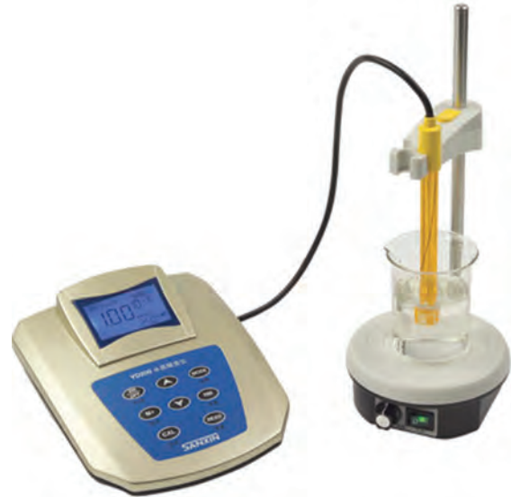
شکل ۹-۴ دستگاه سنجش سختی آب
