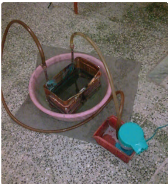
شکل ۲۰-۴- رسوب‌زدایی با پمپ
