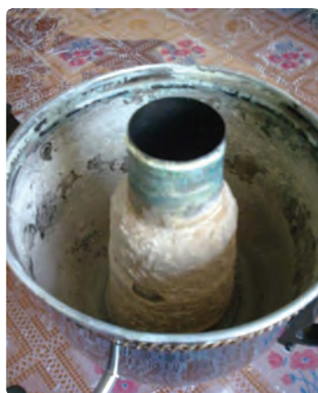
شکل ۴-۸- تشکیل رسوب در سماور و لوله ها
