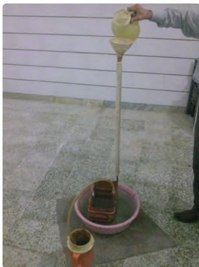
شکل ۱۸-۴- اسید خروجی از ظرف دوم باید بدون کف باشد.
