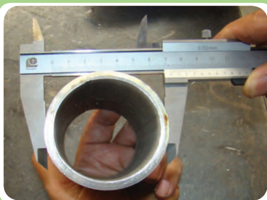
اندازه‌گیری قطر خارجی لوله توسط کولیس
