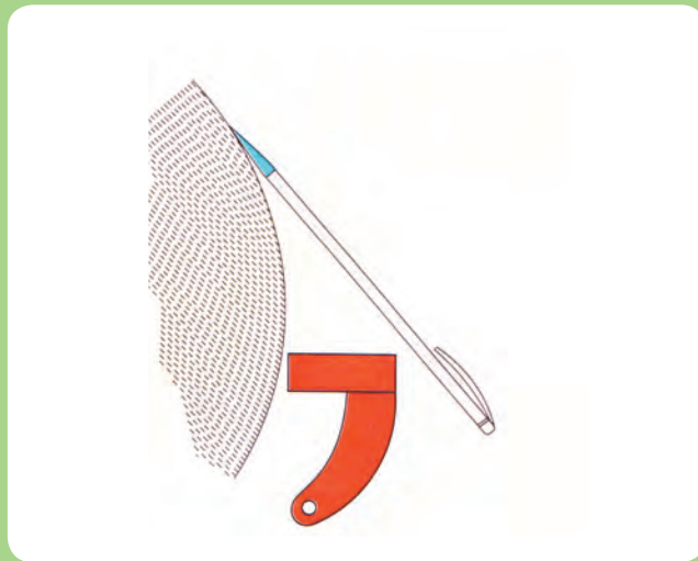
تیز کردن سوزن خط کش
