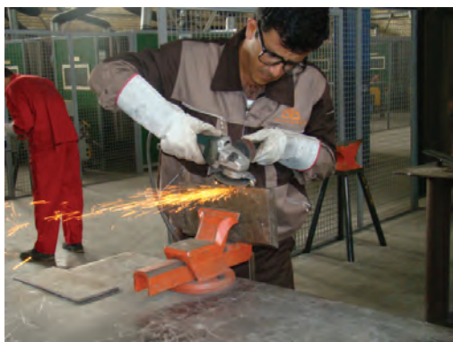
تشخیص نوع فولاد بر اساس آزمایش جرقه
