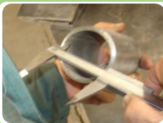
اندازه‌گیری قطر داخلی لوله توسط کولیس
