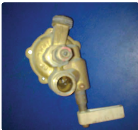
شکل ۹-۱- رگولاتور آب
