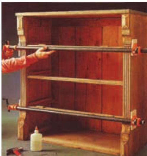
شکل ۱۸- ۱۱- چسباندن اتصالات جدا شده.
