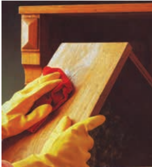
شکل ۲۲-۱۱. پاک کردن سطح کار پس از آستری.
