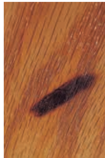
شکل ۱۱-۱ اثر اکسیداسیون روی سطح.
