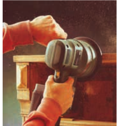
شکل ۲۰-۱۱. پرداخت سطح کار.
