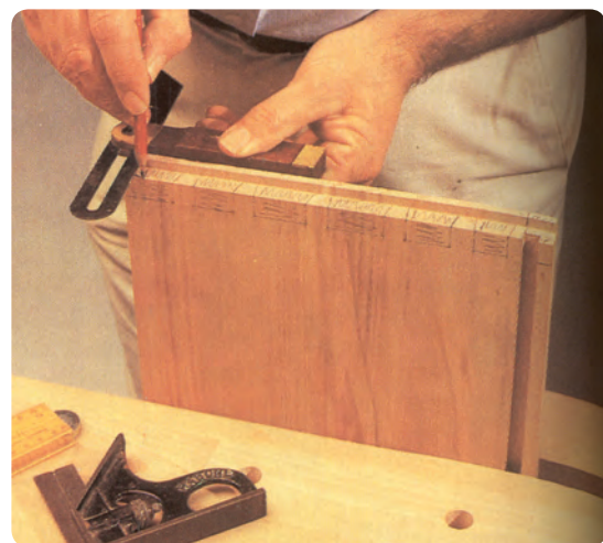
شکل ۶-۱۳۶ خط‌کشی اتصال دم‌چلچله دورو مخفی
