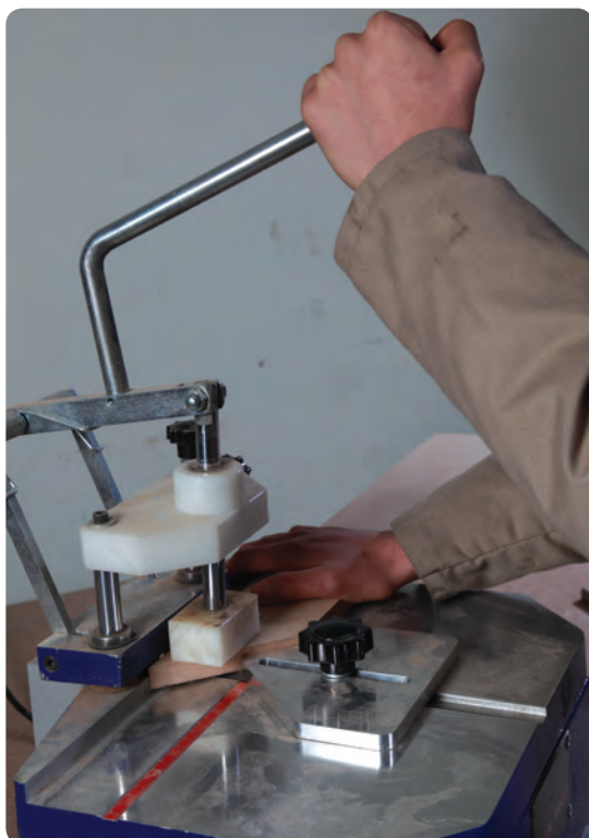
شکل ۹۳-۶ اتصال دم چلچله زن پروفیل
