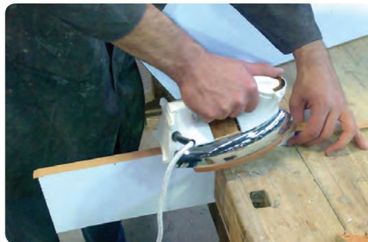
شکل ۶-۸۱ لبه چسبانی روکش مصنوعی با اتو
