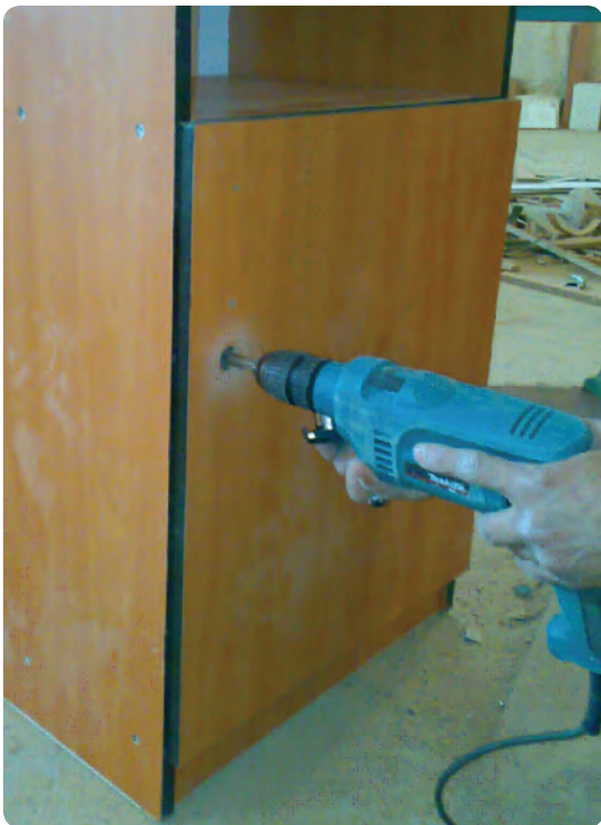
شکل ۱۲۳-۶ در آوردن جای قفل سوئیچی
