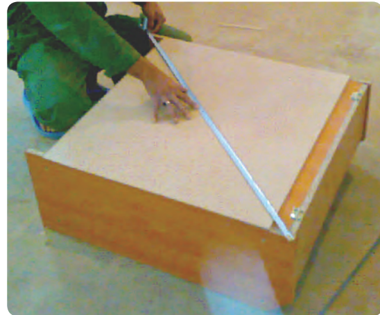
شکل ۶-۱۳۰ کنترل دویدگی کابینت
