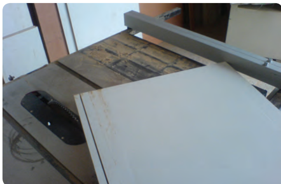
شکل ۶-۶۹- کنشکاف زدن جهت پشت بند
