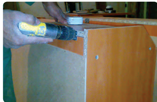
شکل ۶-۱۳۱ نصب لولای محفظه جاواکسی
