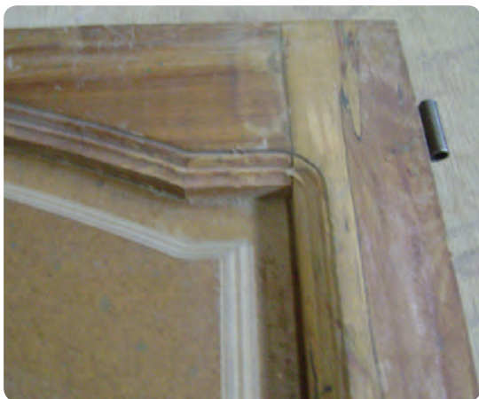
شکل ۶-۸۹ ابزار زدن قاب و تنکه
