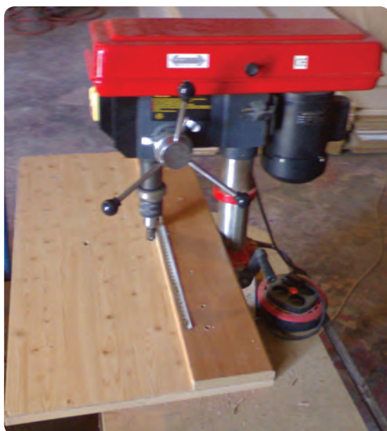
شکل ۶-۷۰- دریل ستونی همراه با شابلون جهت سوراخ‌کاری
