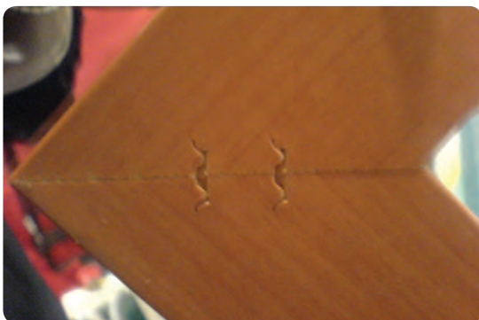
شکل ۹۴-۶ اتصال دوخت قاب
