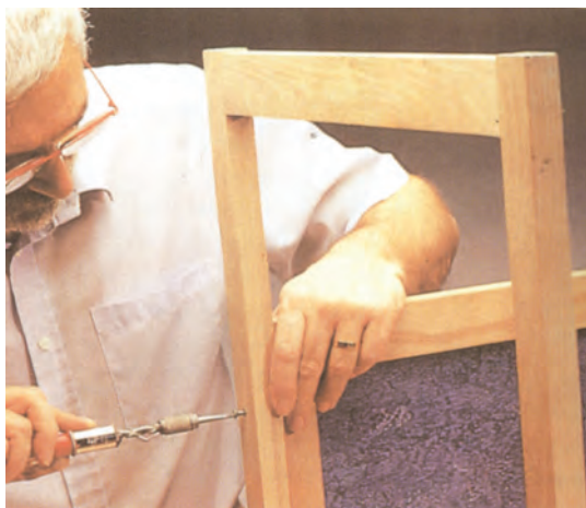
شکل ۶-۱۶۰ مونتاژ قاب پشت با قاب کناری
