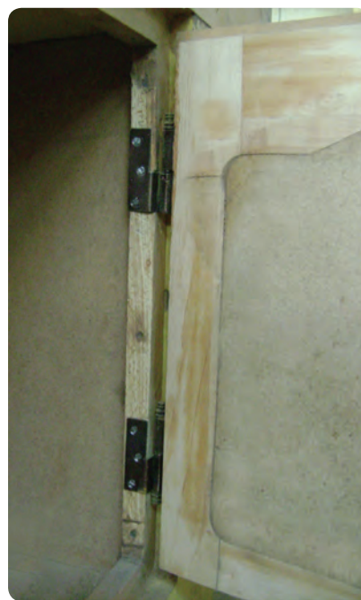
شکل ۶-۸۸ در قاب تنکه‌ای با لولای قابلمه‌ای
