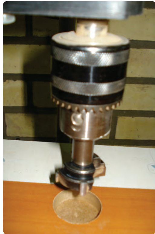
شکل ۶-۷۱ مته کابینت جهت سوراخ کردن جای لولا
