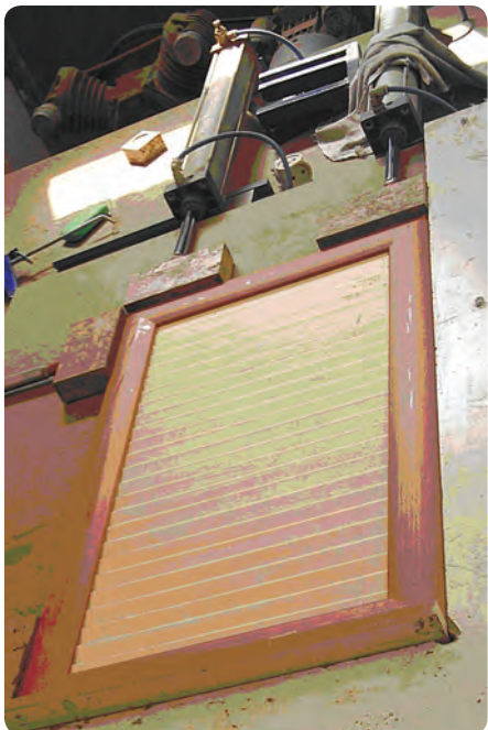
شکل ۶-۹۷ تنگ نیوماتیکی جهت مونتاژ در قابدار کابینت
