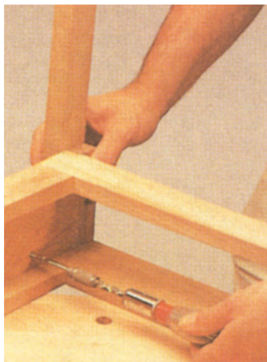
شکل ۶-۱۵۹ اتصال قاب دراور به قاب کناری
