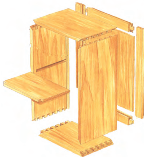
شکل ۶-۱۳۳ پرسپکتیو انفجاری کابینت
