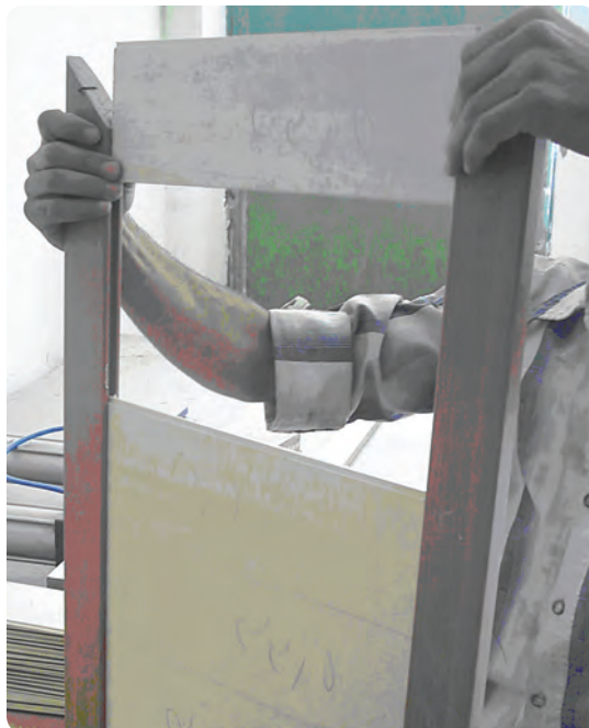
شکل ۶-۹۵ مونتاژ در قابدار با تنگه لته‌ای
