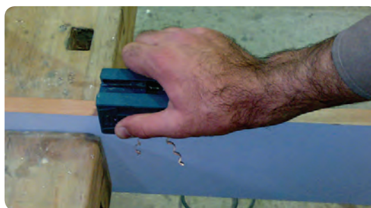
شکل ۶-۸۲ پرداخت لبه اضافی روکش
