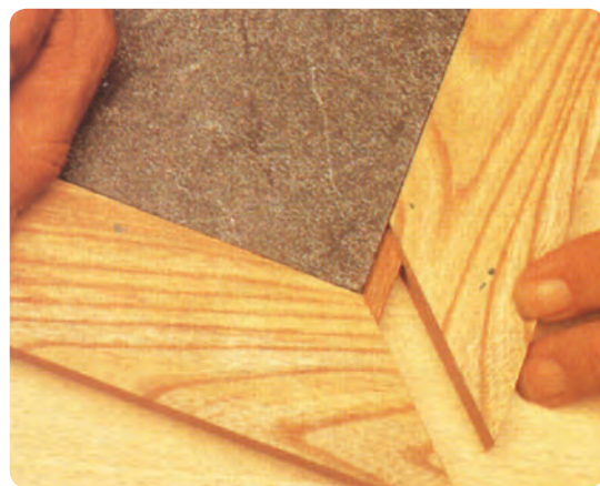
شکل ۶-۱۵۲ مونتاژ صفحه میز
