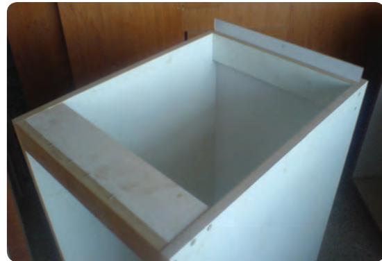
شکل ۶-۷۵ - مونتاژ کابینت با قرارگیری پشت‌بند
