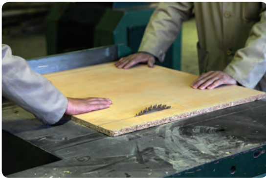
شکل ۶-۷۷ - برش در ساده کابینت
