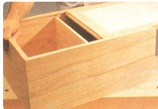
شکل ۶-۱۴۳ قرارگیری پشت بند در کنشکاف بدنه کابینت
