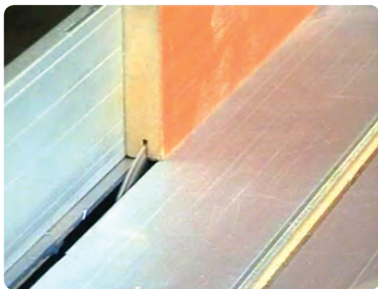
شکل ۶-۹۰ دو راهه‌کردن با ماشین اره مجموعه‌ای
