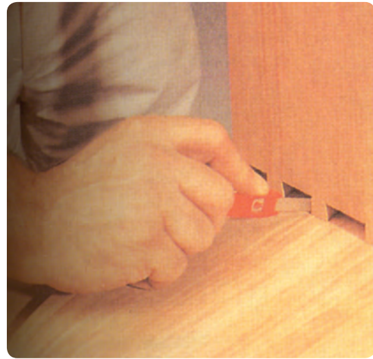
شکل ۶-۱۳۸ خط‌کشی جای فاق روی قطعه دیگر
