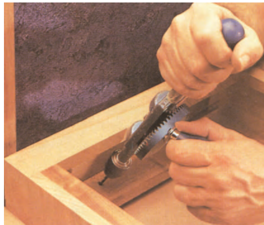
شکل ۱۶۱- مونتاژ صفحه میز به قاب دراور
