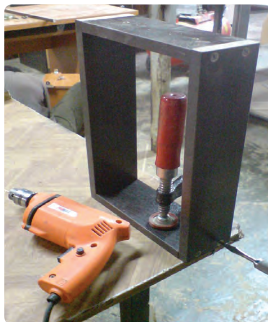
شکل ۶-۱۰۸ مونتاژ دستی جعبه کشو
