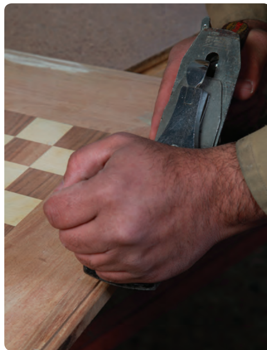
شکل ۷۹-۶ رنده کردن زهوار چوبی
