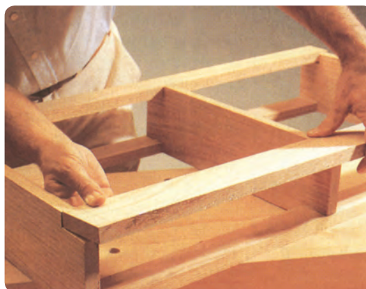
شکل ۶-۱۵۵ مونتاژ کلاف قاب دراور
