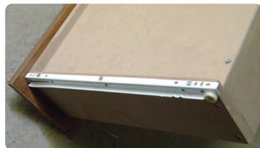
شکل ۶-۱۱۲ نصب ریل مکانیکی در زیر بدنه جعبه
