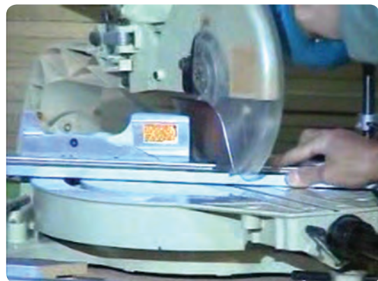
شکل ۹۲-۶ برش پروفیل‌ها با دستگاه فارسی بر
