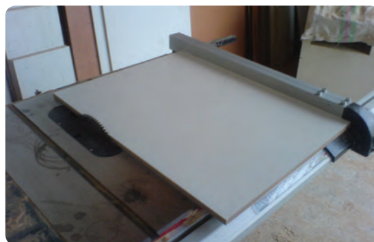
شکل ۶-۶۷- برش صفحات با اره مجموعه‌ای
