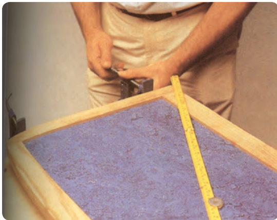
شکل ۶-۱۵۳ تنگ بستن صفحه میز
