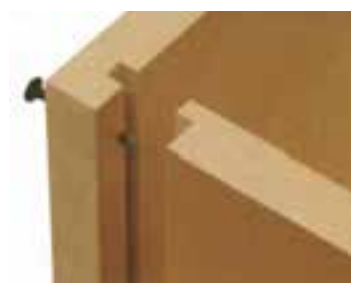
شکل ۴-۴۰- تصویر مجسم پشت بند و بدنه کار که به وسیله‌ی دو راهه و کنشکاف با پیچ محکم می‌شود.
