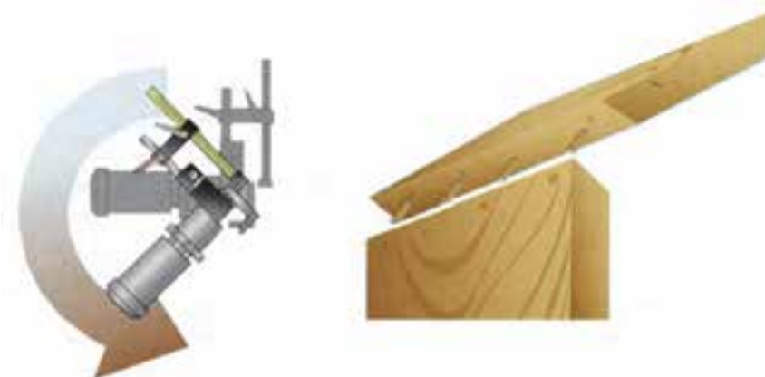
شکل ۴-۹۳ - اتصال دوبل ماشینی
