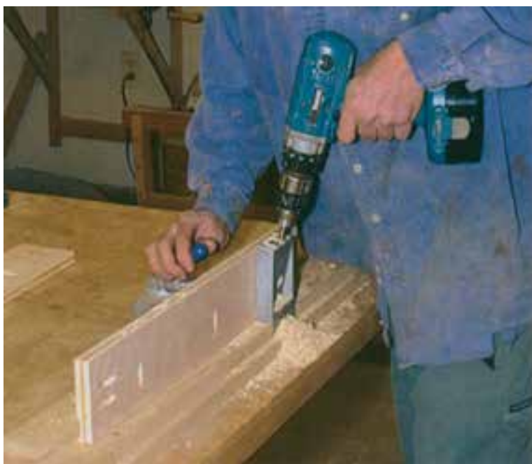
شکل ۴-۹۵- عملیات سوراخ‌کاری اتصال مورّب با پیچ به وسیله‌ی شابلون مربوط
