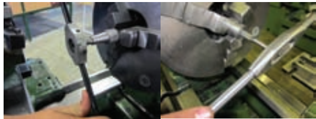
۴- تنظیم کردن نوک لبه رنده در مرکز کار
