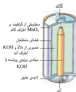
شکل ب باتری قلیایی. ولتاژ این باتری ها در هنگام کشیده شدن جریان الکتریکی بالا، از ثبات نسبی بهتری برخوردار است.
