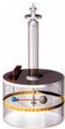
شکل ۲-۲۰- ترازوی پیچشی کولن
