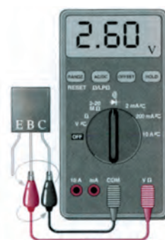
شکل ۱۲-۵۶ ترانزیستور معیوب (قطع)
