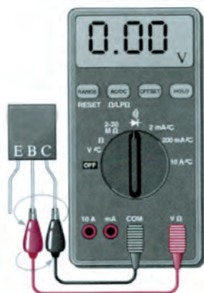
شکل ۱۲-۵۷ ترانزیستور معیوب (اتصال کوتاه)
