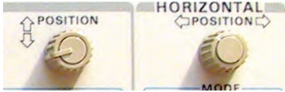
شکل ۶-۳۴ X Position و Y Position
