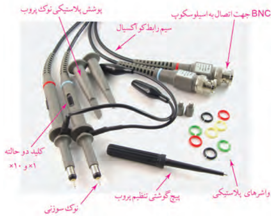
شکل ۵-۶ پروب و اجزای آن
