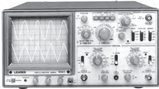
شکل ۶-۳۵ نمایش همزمان دو شکل موج توسط اسیلوسکوپ
