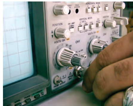
شکل ۶-۶ نحوه‌ی اتصال BNC به اسیلوسکوپ
