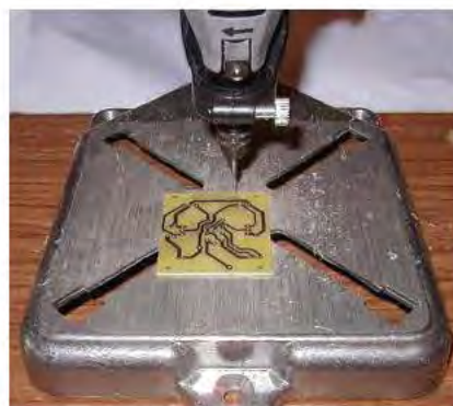
شکل ۷-۸ سوراخ کاری با دریل برقی
