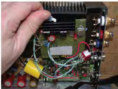
شکل ۷-۱۴ محل نصب هیت سینک
