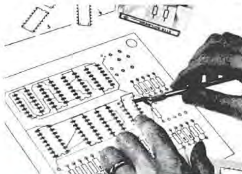
شکل ۷-۳۵ نحوه‌ی چسباندن لتراست مربوط به پایه قطعات
