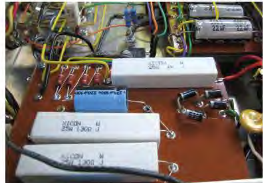
شکل ۷-۱ فیبر مدار چاپی به روش قدیمی
