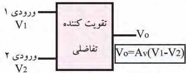
شکل ۵-۱ بلوک دیاگرام تقویت کننده تفاضلی
