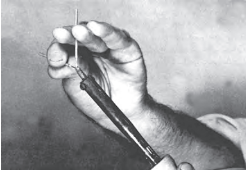
شکل ۵۹-۳- نحوه صحیح در دست گرفتن سیم و هویه برای عمل لحیم کاری
