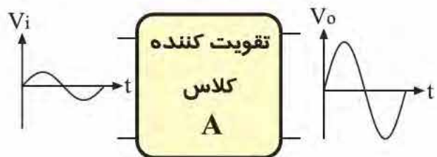
شکل ۳-۱ سیگنال‌های ورودی و خروجی در تقویت کننده کلاس A
