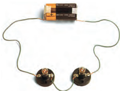
شکل ۲۹-۲ مدار واقعی دو لامپ به صورت سری
