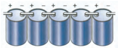
شکل ۲-۱۲۰ اتصال سری پیل‌ها
