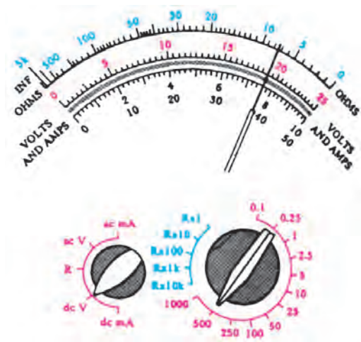
شکل ۹۰-۲ صفحه مولتی متر عقربه‌ای
