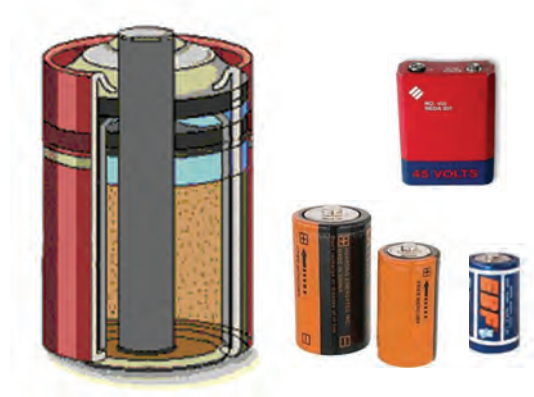
شکل ۲-۱۱۳ نمونه ای از پیل های روی-کربن
