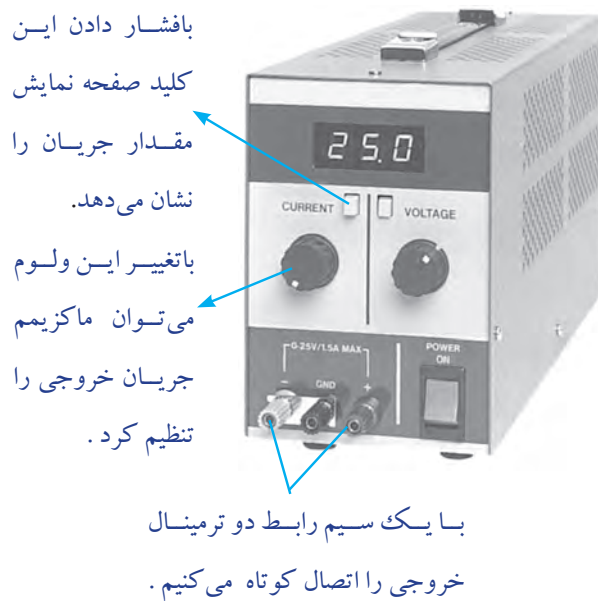
شکل ۸۹-۲ نحوه‌ی تنظیم جریان خروجی یک منبع تغذیه
