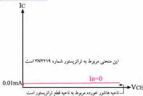
شکل ۱۲-۱ ناحیه قطع در منحنی مشخصه ی خروجی ترانزیستور
