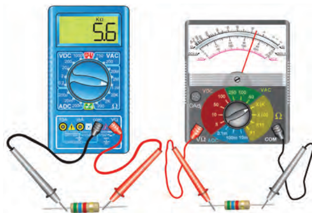
شکل ۱-۳۹ استفاده صحیح از حوزه ی کار صحیح دستگاه اندازه گیری
