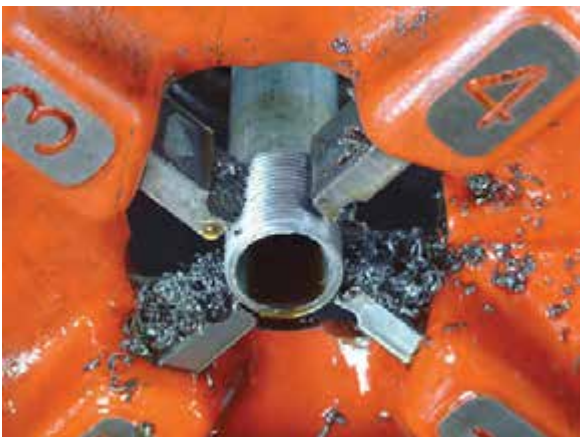
شکل ۴-۱۱۶ طول مناسب دنده
