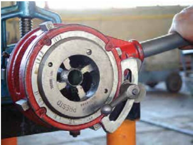
شکل ۱۲۴-۴- عمل حديد‌کاري تا عبور پارچه‌ها از لبه‌ی لوله
