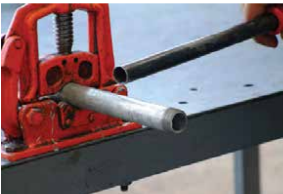
شکل ۴-۱۱۷ جداسازی پلیسه از سر دنده
