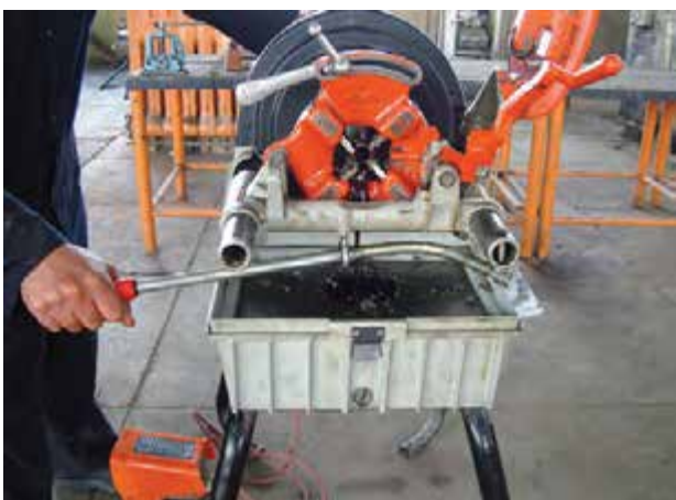
شکل ۱۳۳-۴ عمل حدیده کاری لوله
