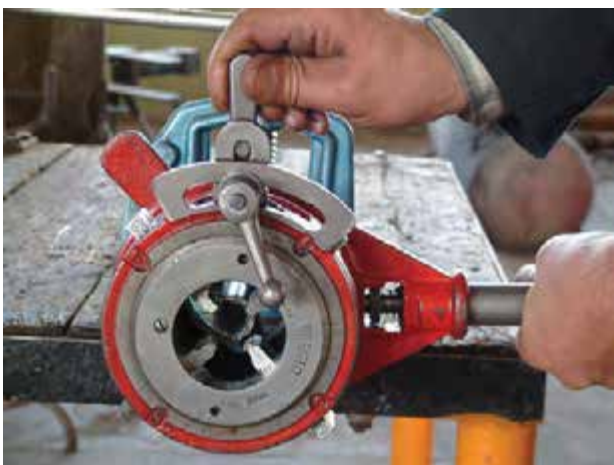
شکل ۱۲۵-۴- کم کردن بار پارچه‌هاي حديد
