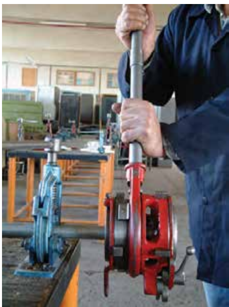
شکل ۱۲۶-۴- باز کردن حدیده از لوله
