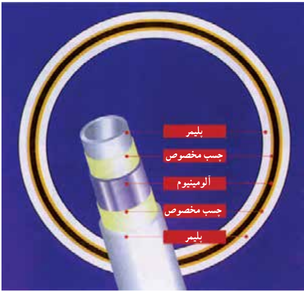
شکل ۲۰-۵- ساختار لوله‌ی پلی اتیلن پنج لایه
