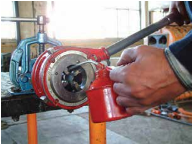
شکل ۱۲۳-۴- استفاده از روغن‌دان در جریان حديد‌کاري
