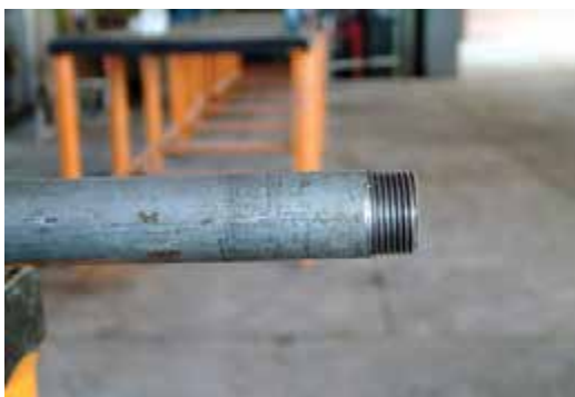
شکل ۴-۵- لوله‌ی فولادی گالوانیزه
