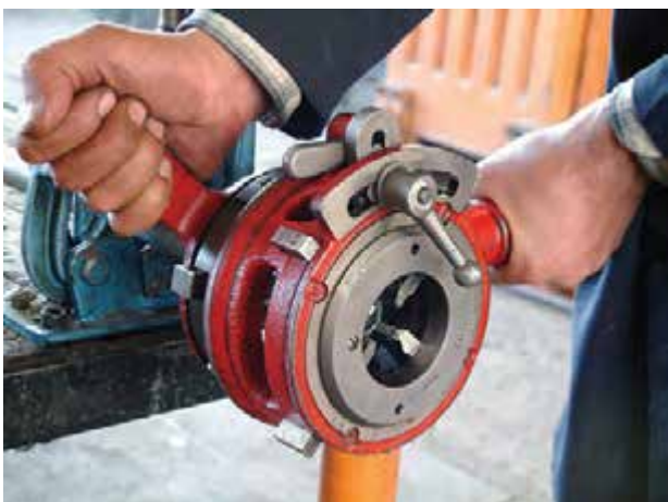
شکل ۴-۱۲۰- بستن اهرم فلکه‌ی چهار نظام
