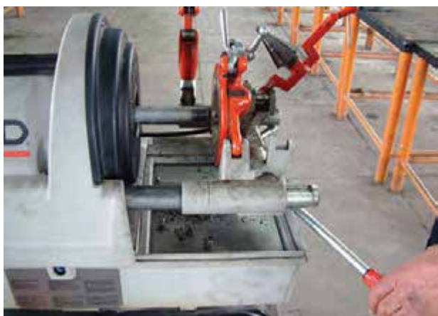
شکل ۱۴۰-۴- پایان عمل حدیده کاری
