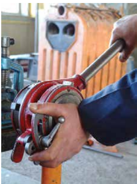
شکل ۴-۱۲۲- عمل درگیر کردن پارچه‌ها با سر لوله
