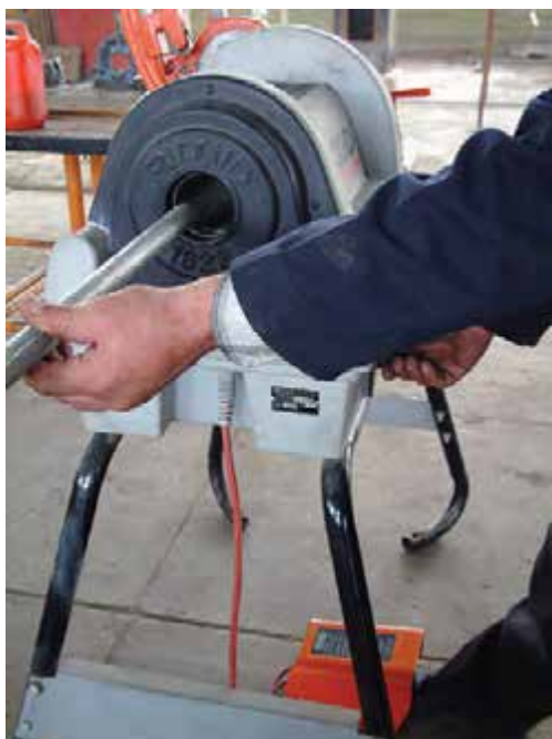
شکل ۱۳۱-۴- قراردادن لوله در حدیده‌ی ماشینی
