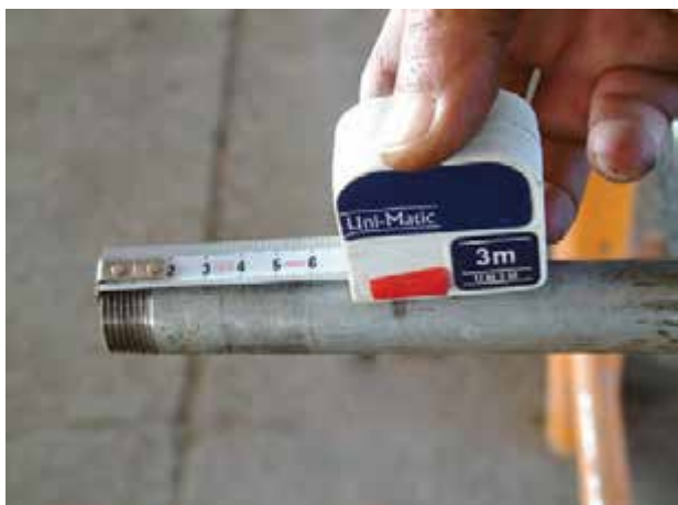
شکل ۱۲۸-۴- اندازه‌گیری لوله‌ی حدیده شده
