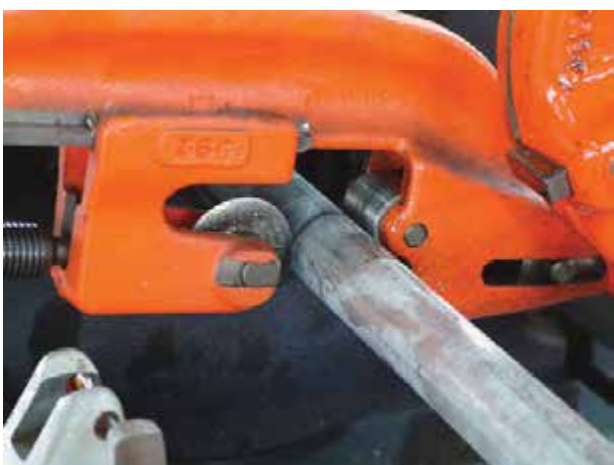
شکل ۴-۱۳۷- بریدن لوله به وسیله ی لوله بُر
