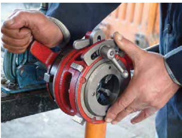
شکل ۴-۱۱۴- سفت کردن فلکه‌ی چهار نظام
