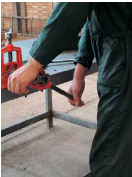
شکل ۴-۱۱۲- حدیده‌ی متناسب با قطر لوله
