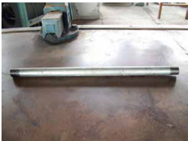
شکل ۱۴۱-۴- لوله‌ی دو سر دنده شده
