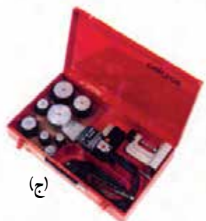
شکل ۲۶-۵- دستگاه جوش لوله‌های پلی پروپیلنی و قالب‌های مربوطه
