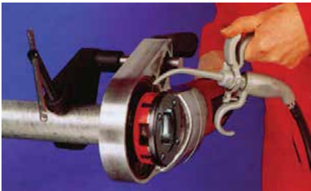
شکل ۴-۱۰۸- استفاده از روغن‌دان در جریان لوله‌کشی
