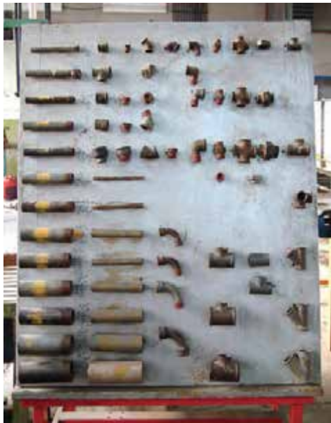
شکل ۳۵-۵- انواع لوله و فیتینگ‌های دنده‌ای
