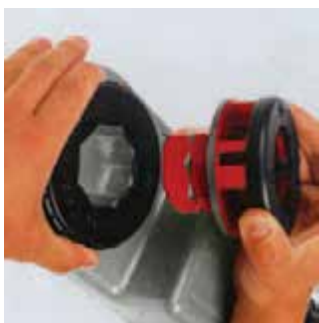
شکل ۴-۱۰۴ - تعویض پارچه‌های حدیده
