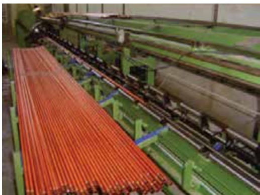
شکل ۹-۵- لوله‌ی مسی به صورت شاخه‌ای
