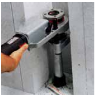
شکل ۴-۱۰۵ - طرز استفاده از حدیده
