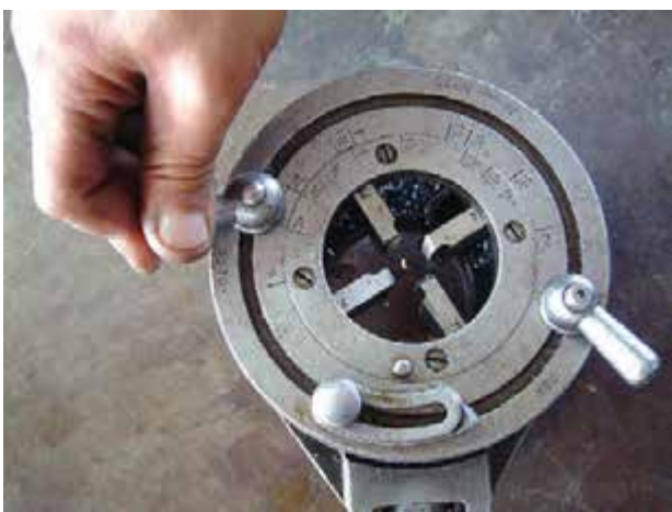
شکل ۴-۶۲- سفت کردن مهره‌های ثابت‌کننده‌ی رینگ متحرک
