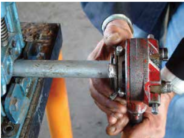
شکل ۳۹-۴ باز کردن فلکهای چهارنظام
