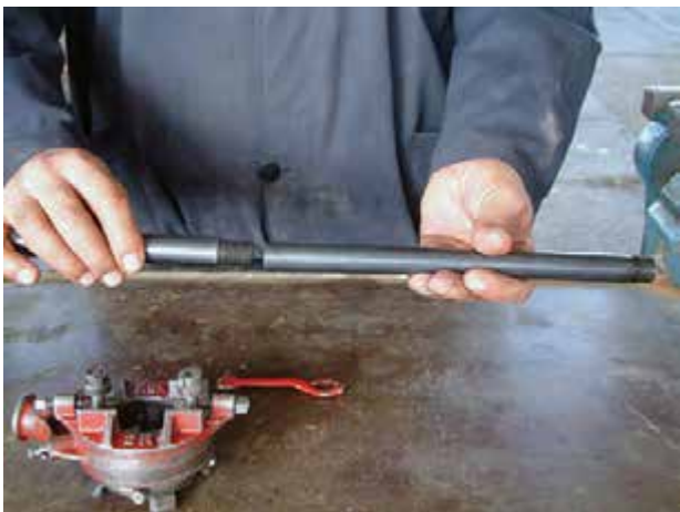
شکل ۴-۲۴ اتصال دسته‌ی دو تکه به یک‌دیگر
