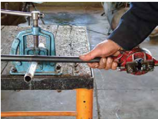
شکل ۴۰-۴ جدا کردن پلیسه‌ها از سردنده
