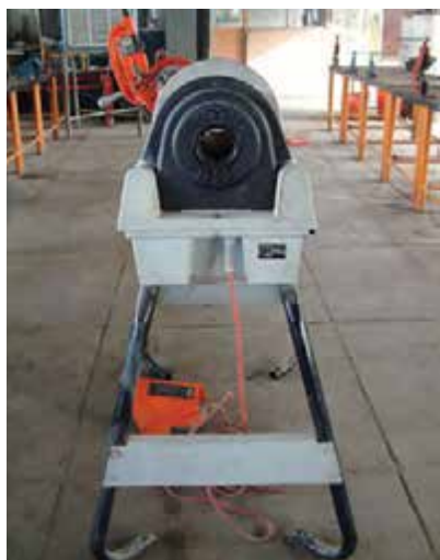
شکل ۴-۷۵- حدیده‌ی ماشینی سیار نصب شده بر روی پایه
