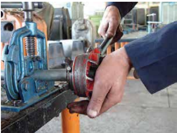
شکل ۳۳-۴- درگیر نمودن پارچه‌های حدیده با لوله
