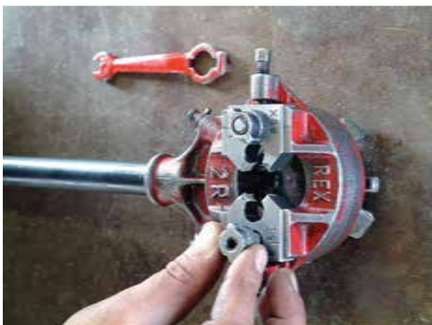
شکل ۴-۲۷- بستن مهره‌ها بر روی پارچه‌های حدیده
