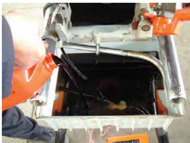
شکل ۴-۸۳- مخزن روغن حدیده‌ی ماشینی
