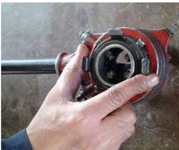
شکل ۴-۲۱- فلکه‌ی چهار نظام حدیده‌ی دستی دو پارچه
