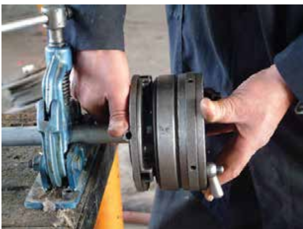
شکل ۴-۶۴- سفت کردن سه نظام حدیده
