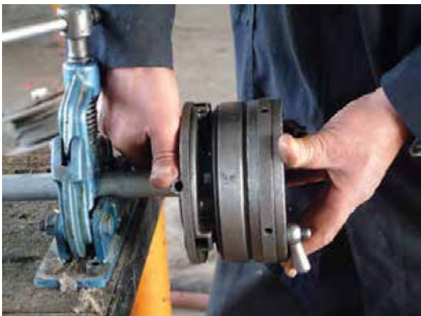
شکل ۴-۷۱- باز کردن سه نظام حدیده
