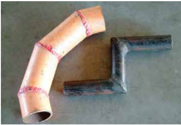
شکل ۴-۴- استفاده از جوش‌کاری در ساخت زانوی چند تکه
