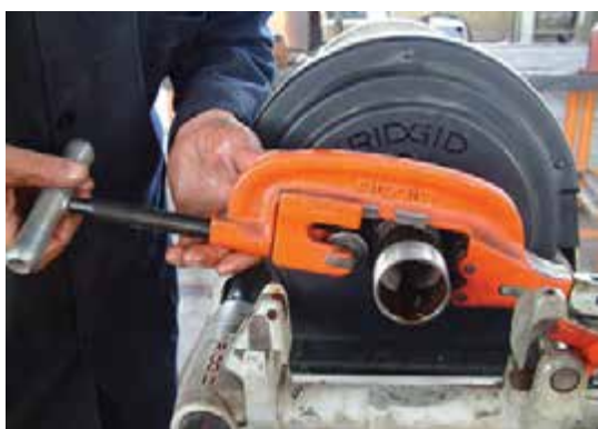
شکل ۴-۱۰۱- بریدن لوله به وسیله‌ی لوله‌بُر
