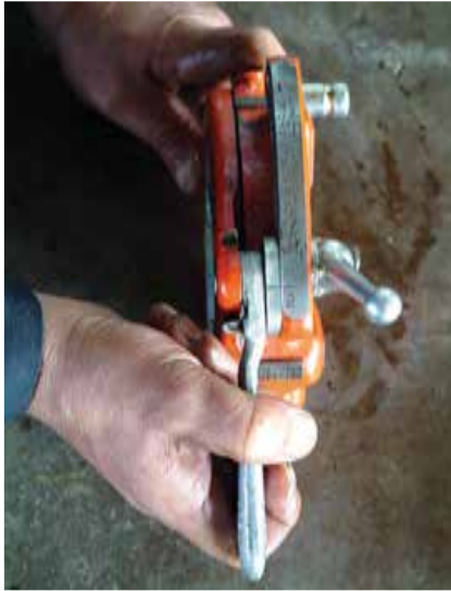
شکل ۴-۹۳- تنظیم حدیده به اندازه‌ی لوله‌ی ۲ اینچ
