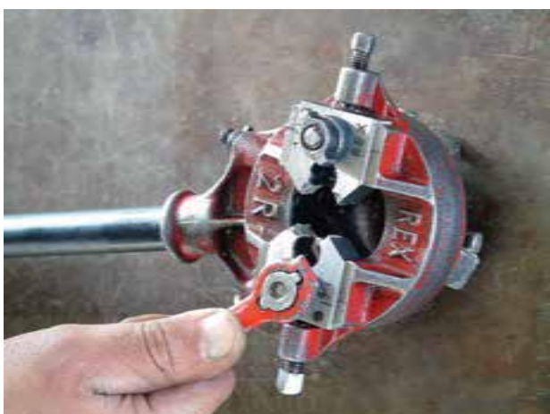
شکل ۴-۲۸- سفت کردن مهره به وسیله‌ی آچار حدیده
