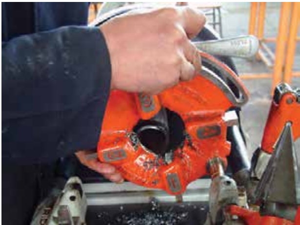
شکل ۴-۹۰- جدا کردن تنه‌ی حدیده از دستگاه
