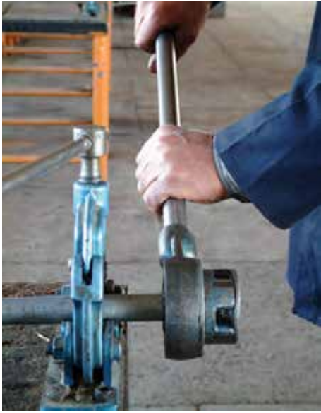
شکل ۴-۴۸- عمل حدیده کاری
