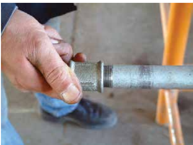
شکل ۴۱-۴ کنترل بار سردنده به وسیله‌ی یک فیتینگ
