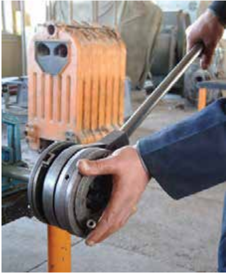
شکل ۴-۶۶- درگیر کردن حدیده با سر لوله
