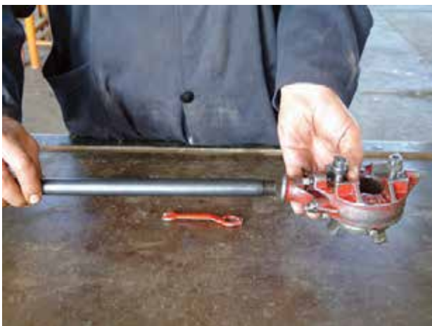
شکل ۴-۲۵ اتصال دسته‌ی حدیده به بدنه‌ی حدیده
