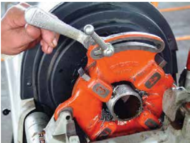
شکل ۴-۷۸- عمل حدیده‌کاری با حدیده‌ی ماشینی
