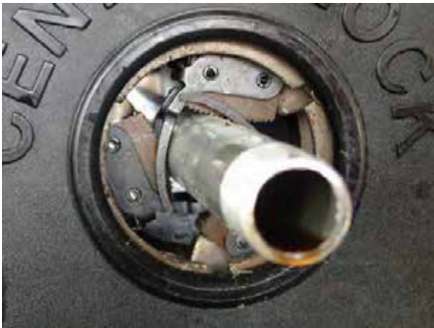
شکل ۴-۷۳- سه نظام ثانویه حدیده‌ی ماشینی
