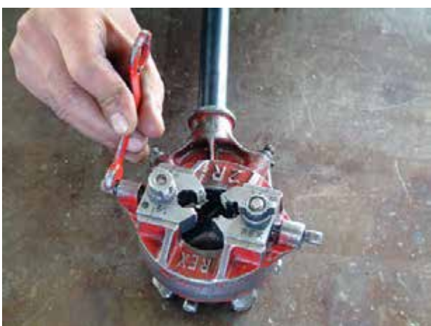
شکل ۴-۲۹- تنظیم کردن حدیده به وسیله‌ی آچار حدیده
