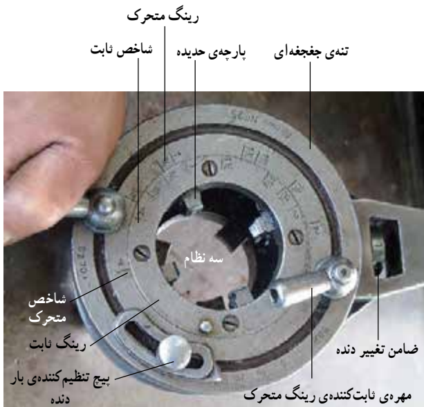
شکل ۴-۵۵- اجزای حدیده‌ی دستی چهارپارچه
