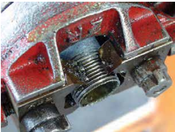
شکل ۴-۳۶- عبور دو دندانه از انتهای پارچه
