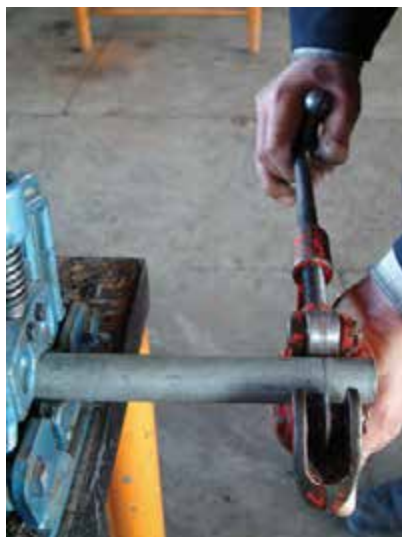
شکل ۴-۷۷- لوله‌بر در حال گردش به دور لوله
