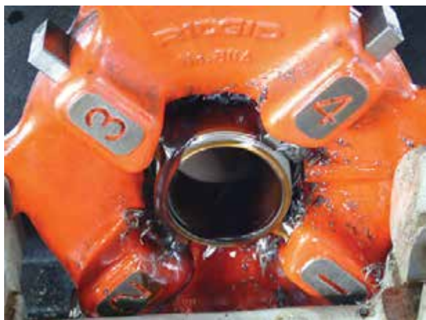
شکل ۴-۸۲- استفاده از روغن در موقع حدیده‌کاری
