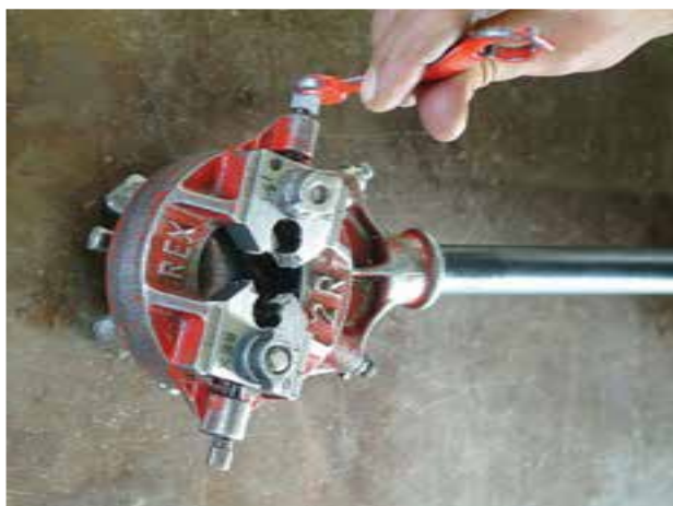
شکل ۲۰-۴- اجزای حدیده‌ی دستی دو پارچه
