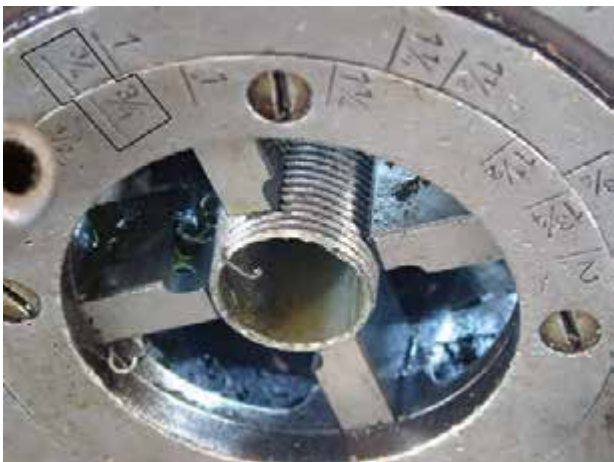
شکل ۴-۶۹- حد صحیح حدیدیه کردن لوله‌ی \frac{3}{4}
