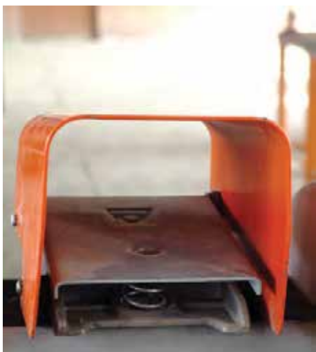
شکل ۴-۸۱- پدال خاموش و روشن کردن دستگاه در بعضی از حدیده‌های ماشینی
