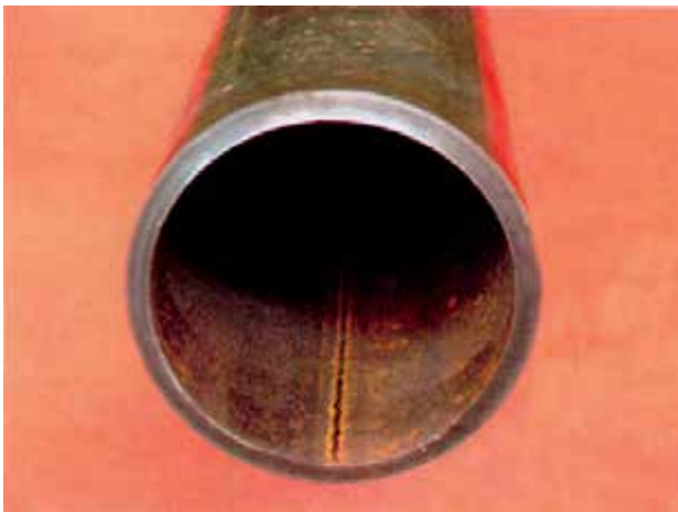
شکل ۴-۱۱- لوله‌ی فولادی سیاه درزدار
