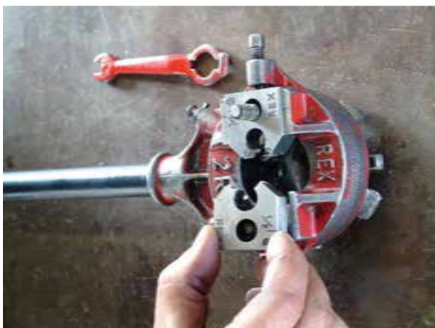
شکل ۴-۲۶ قرار دادن پارچه‌ها در محل خود
