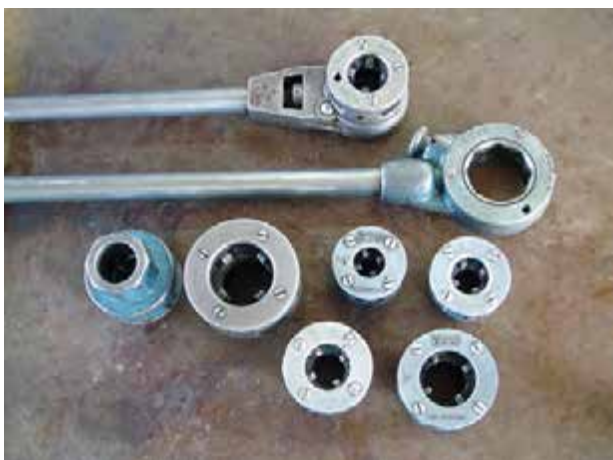
شکل ۴-۴۲- حدیده‌ی چهارپارچه‌ی غیر قابل تنظیم
