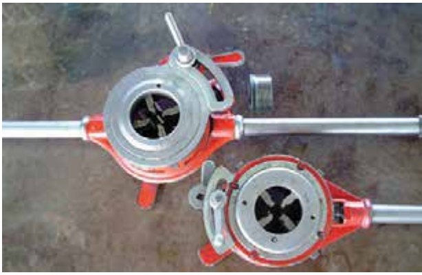
شکل ۴-۵۱- حديددهای دستی چهار پارچه‌ی یک دسته و دو دسته
