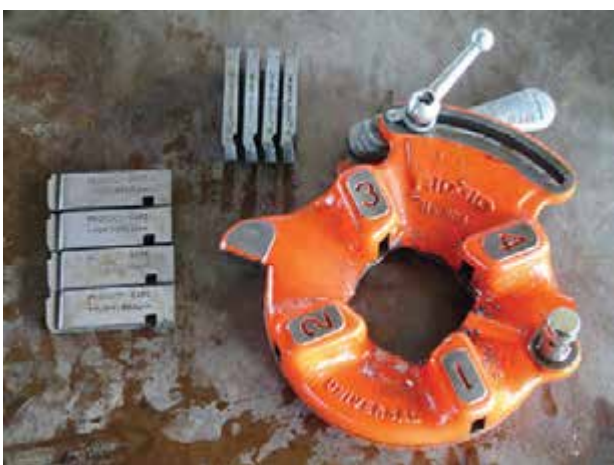
شکل ۸۹-۴- مشخصات حک شده بر روی پارچه‌های حدیده
