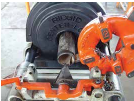
شکل ۴-۱۰۲- شروع عمل بُرقوکاری
