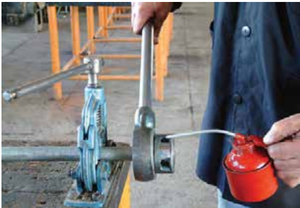
شکل ۴-۴۹- روغن کاری محل تماس پارچه‌ها با لوله
