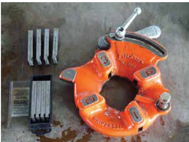
شکل ۸۸-۴- تنه‌ی حدیده و پارچه‌های آن
