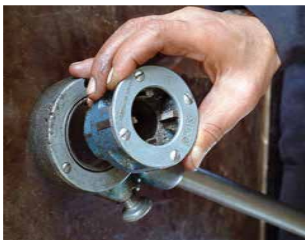
شکل ۴-۴۴- خارج کردن پارچه از بدنه‌ی حدیده
