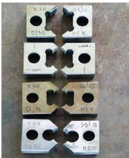
شکل ۴-۲۳- پارچه‌های حدیده‌ی دستی دو پارچه
