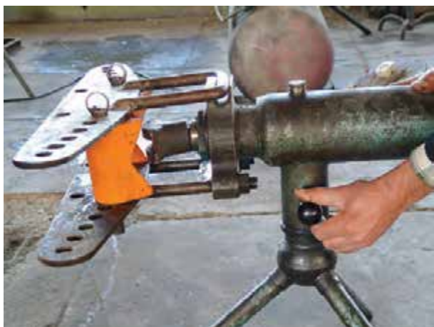
شکل ۳-۲۱- قرار دادن پارچه‌ی خم‌کن در محل خود و سفت کردن پیچ ثابت‌کننده‌ی خم‌کن بر روی سه‌پایه
