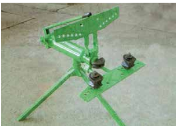
شکل ۳-۴۸- قرار گرفتن لقمه در محل مناسب خود
