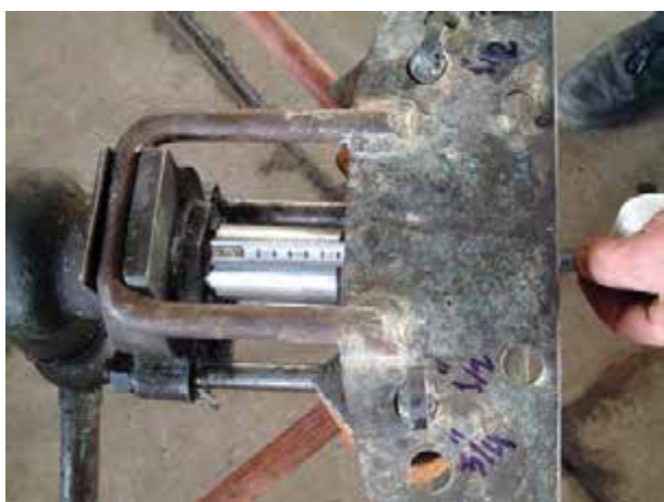
شکل ۲۷-۳- اندازه‌گیری طول بیستون خارج شده از سیلندر
