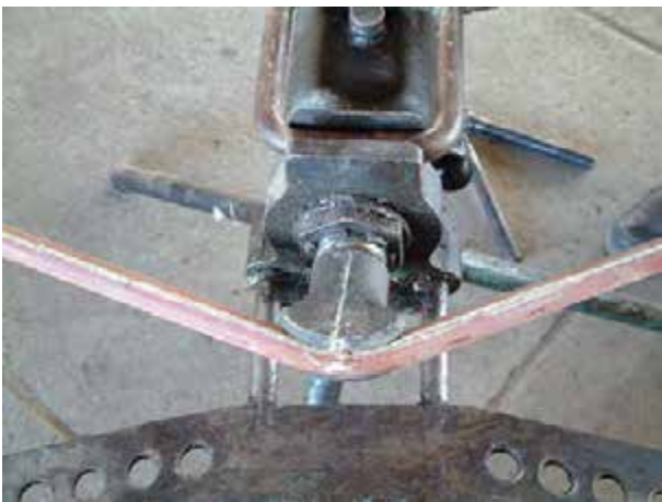
شکل ۳-۲۵- پایان عمل خم‌کاری
