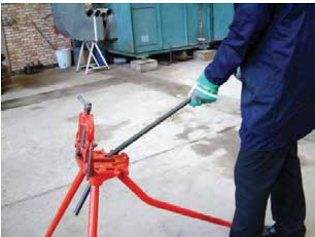
شکل ۳-۹- خم کاری لوله به وسیله‌ی گیره‌ی صحرایی
