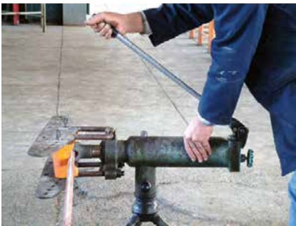
شکل ۱۱-۳- شروع خم کاری
