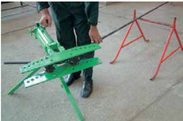
شکل ۳-۴۲- استفاده از خرک در خم‌کاری
