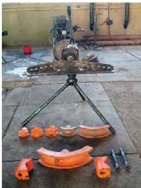
شکل ۱۳-۳- اجزای خم کن هیدرولیکی
