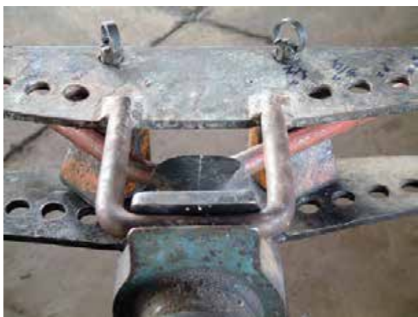
ب- باز کردن خم لوله‌ی خم شده
