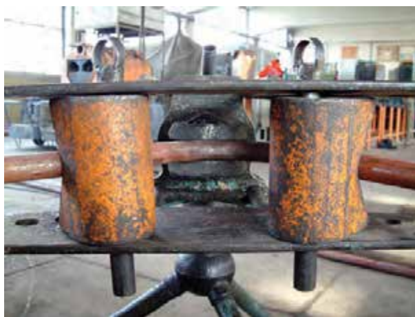
الف- باز کردن خم لوله‌ی خم شده
