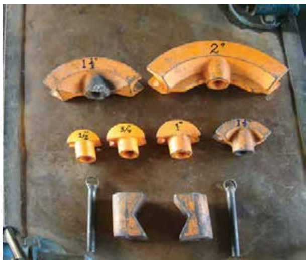
شکل ۳-۲۰- پارچه‌ها و لقمه‌های خم‌کن هیدرولیکی
