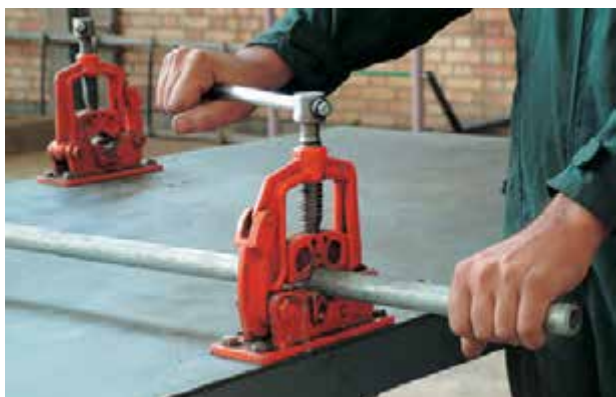
شکل ۳-۵۳- باز کردن شاخه‌ی لوله از گیره‌ی لوله
