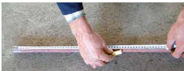
شکل ۳-۵۴- خط‌کشی لوله و تعیین محل‌های خم
