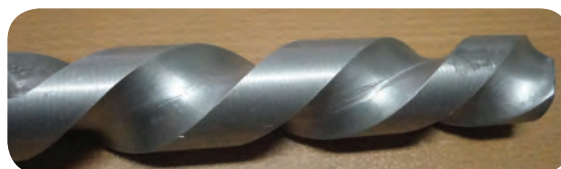
ایجاد شیار مارپیچ در یک میله گرد
